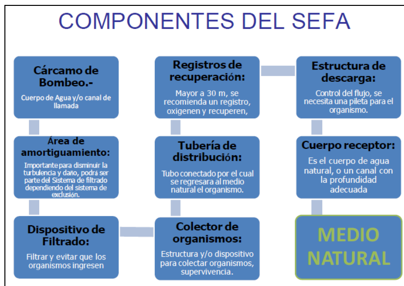
Figura 17. Diagrama de los componentes de Sistema de Exclusión de Fauna Acuática (SEFA).
