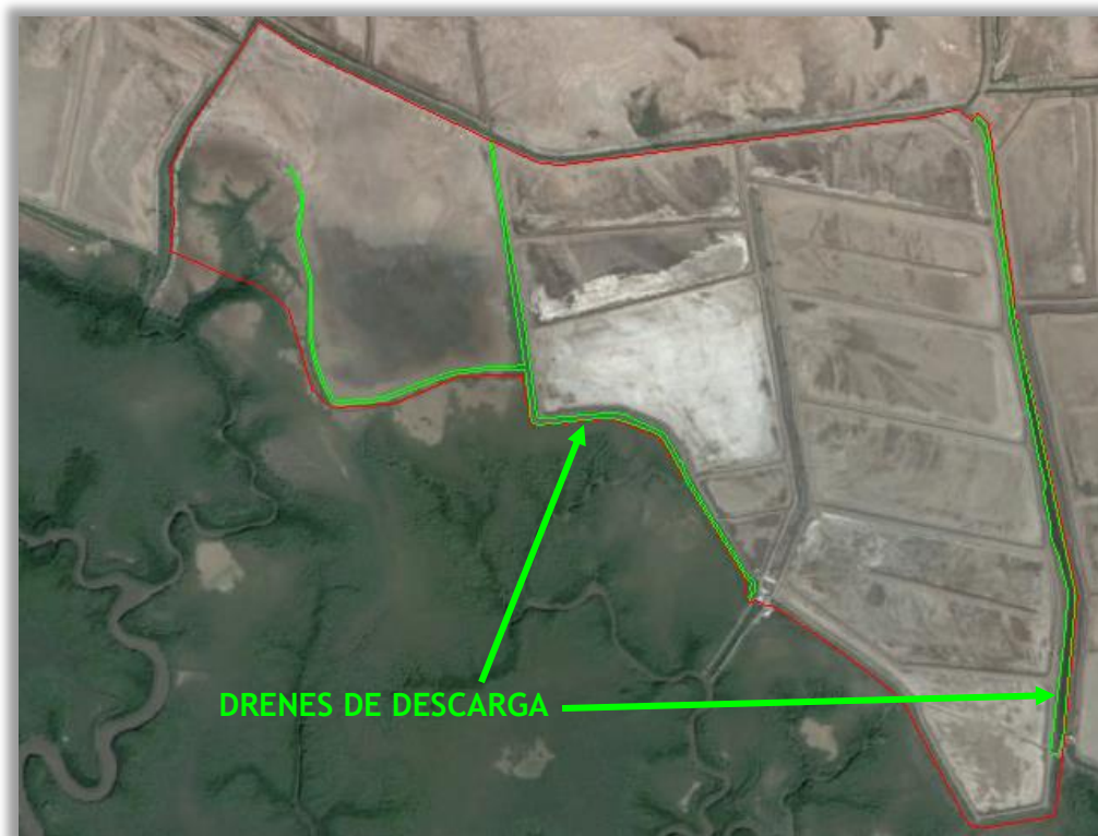
Ilustración 22.- Localización de los drenes de descarga (verde).
