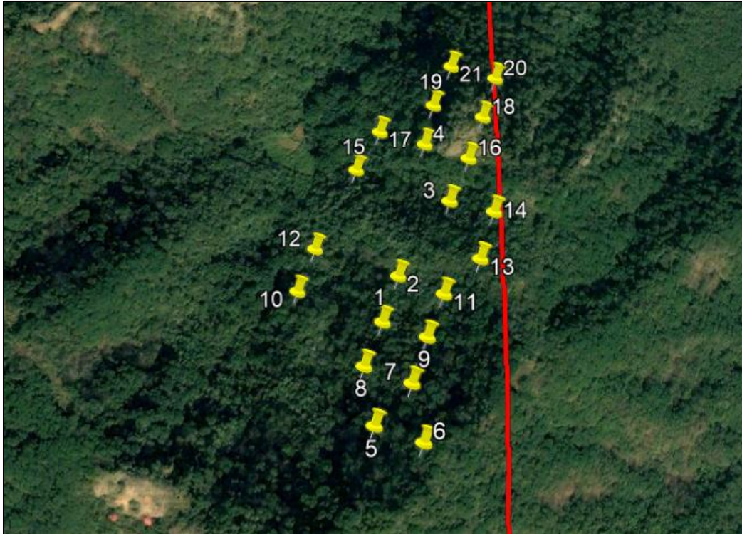
Imagen 7.- Distribución de los barrenos dentro del lote minero los cuervos.
