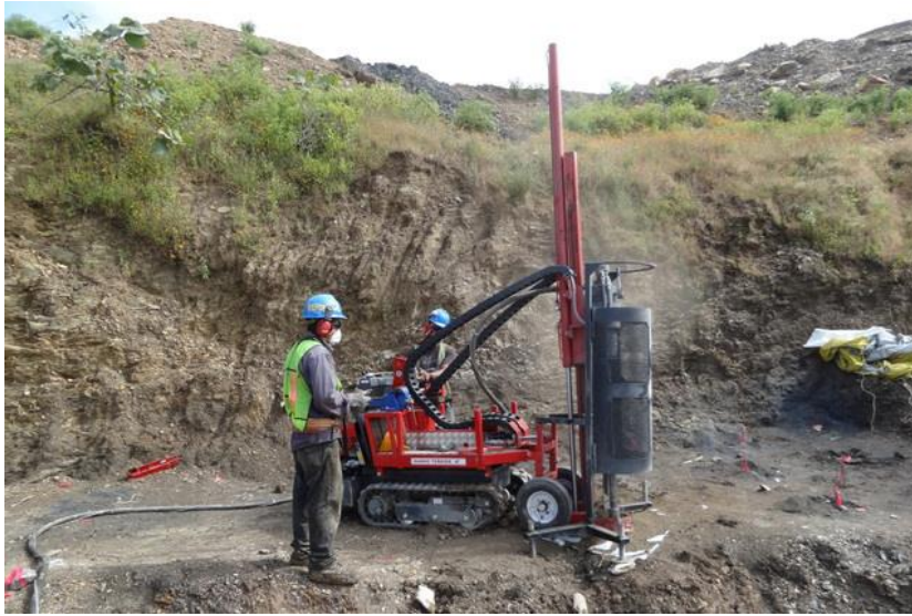
Fotografía III. 3 Ejemplo de maquinaria desarmable y portátil para exploración
