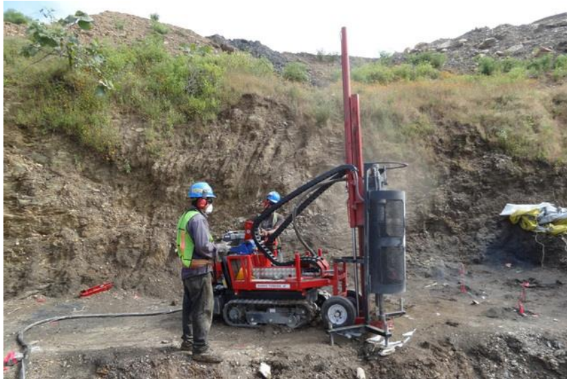
Fotografía III. 4 Ejemplo de maquinaria desarmable y portátil para exploración
