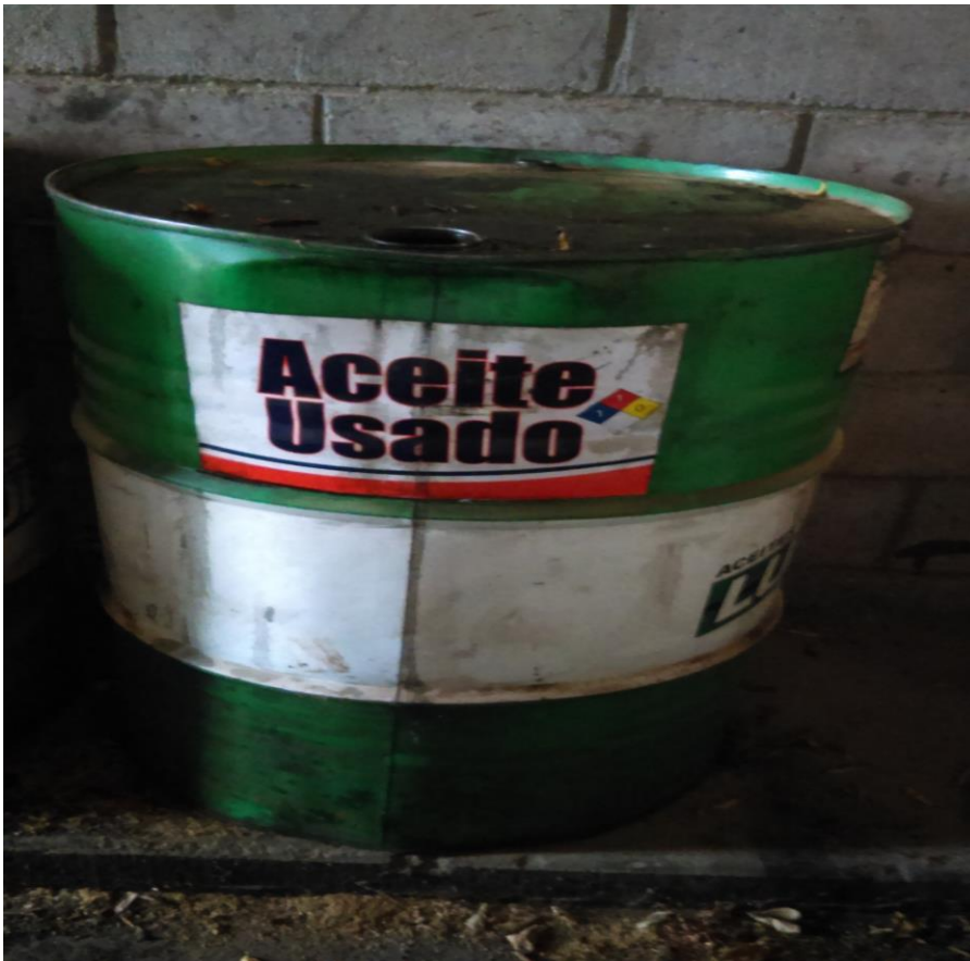
Imagen 15. Tambo de 200 litros rotulado con nombre y código CRETIB del residuo peligroso.
