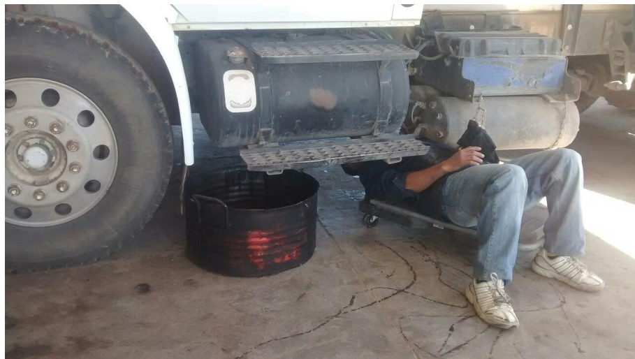
Imagen 14. Charola metálica para evitar derrames.
