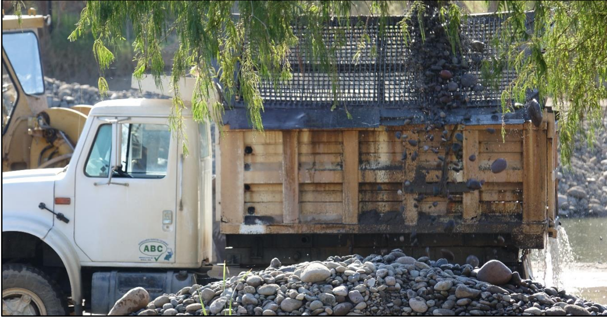
Criba de caballete montada sobre el camión receptor de los materiales pétreos.
