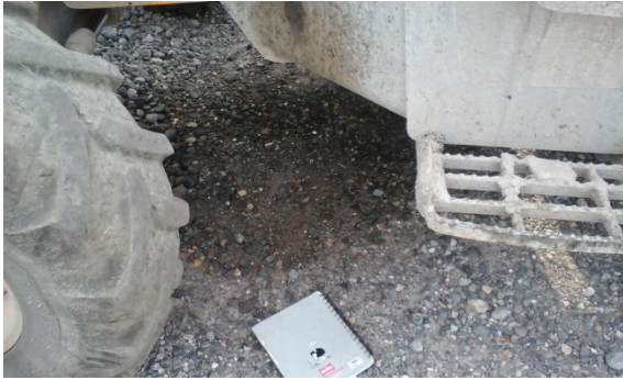
Contaminación del suelo por fuga de hidrocarburo en maquinaria con falla mecánica.
