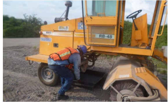
Protección contra fugas de hidrocarburos de maquinaria estacionada.
