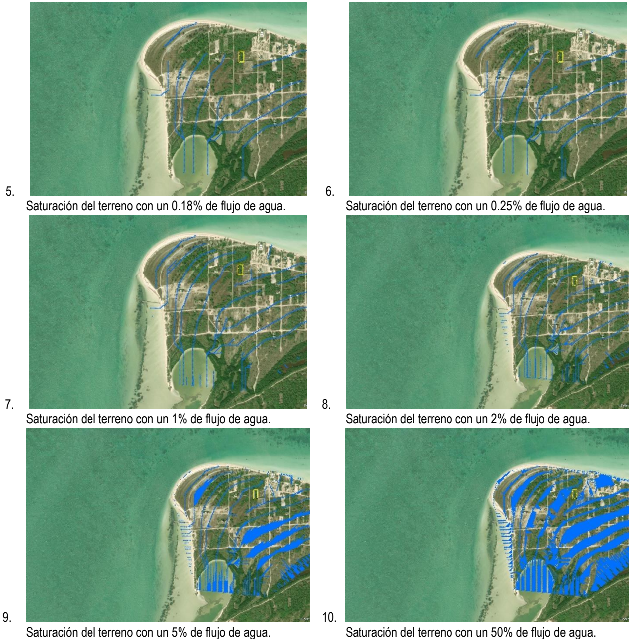
Figura 47. Secuencia de flujo de escurrimiento, como resultado del oleaje de tormenta que se genera durante fenómenos meteorológicos, no se representa incremento del nivel del agua sino la saturación del terreno y la pérdida de la capacidad de absorción del terreno. La línea amarilla marca el límite del predio del proyecto. Los números muestran la secuencia de inundación, el 1 corresponde a 0.05%, y así sucesivamente hasta el número 10, que representa el 50%.
