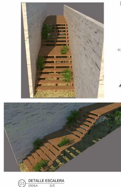
Figura 5. Detalle de construcción de escalera, respetando la forma de crecimiento de los troncos.
