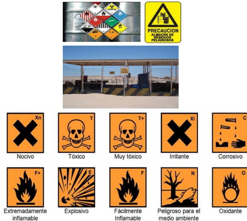
Figura 6.7. Ejemplos de señalamientos para almacenamiento temporal de residuos y atención a contingencias.
