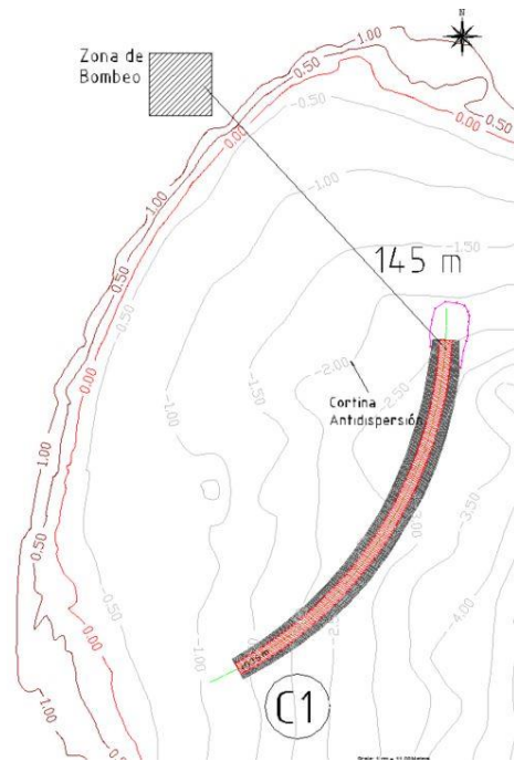
Figura 2.59. Área de bombeo de mortero para la construcción de la estructura C1, así como ubicación de la cortina antidispersión en el área de trabajo.
