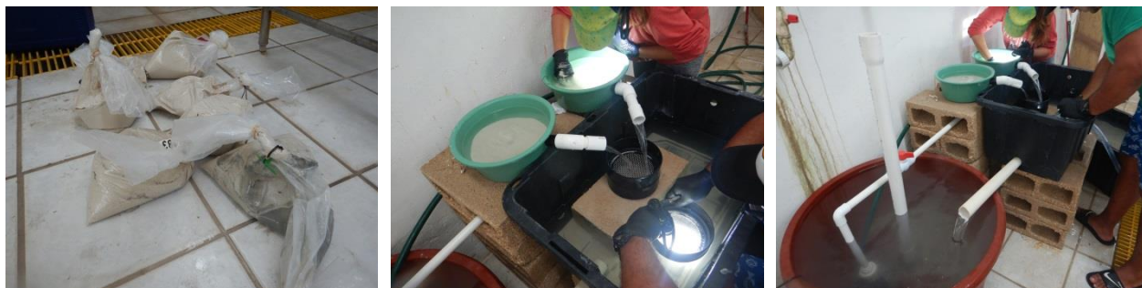
Figura 8. 17. Sistema de filtración para colecta de invertebrados intersticiales de la infauna y muestras de sedimento obtenidas.
