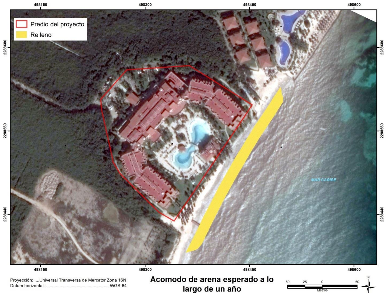
Figura 7. 25 Acomodo esperado del relleno de playa a lo largo de un año.
