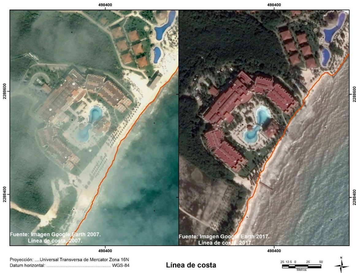
Figura 5. 13. Comparativa de la línea de costa entre los años 2007 y 2017 ajustadas a partir de imágenes satelitales calibradas, adquiridas de la base histórica de Google Earth y compradas sobre una fotogrametría.
