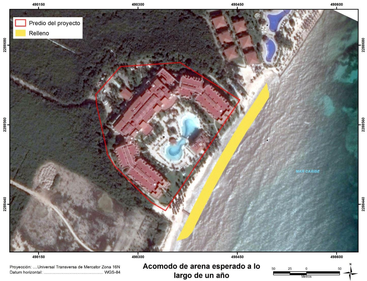
Figura 5. 12 Zona de relleno de playa por parte del proyecto.
