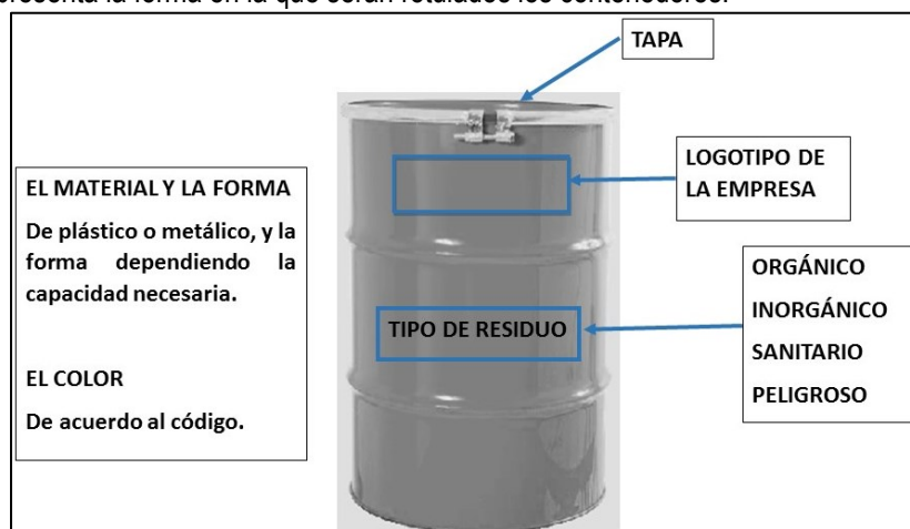
Figura VI-2. Especificaciones de los contenedores de residuos.
