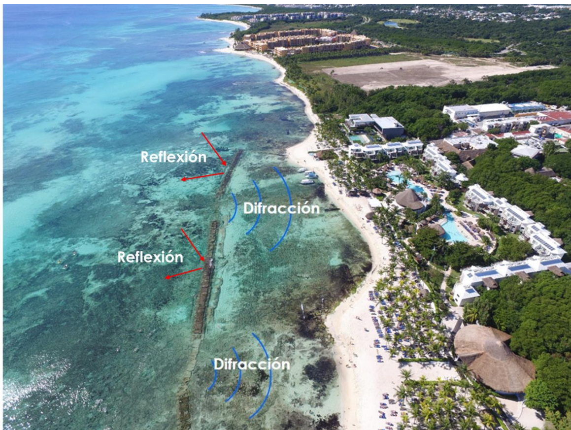
Figura 221. Vista aérea de los dos efectos adversos que producen las estructuras de protección costera existentes frente al Hotel Sandos Caracol Eco Resort.
