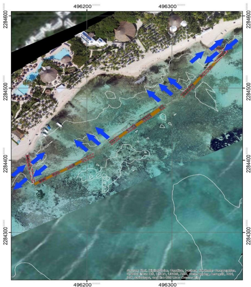
Figura 3. Ubicación de los bolsacretos y efectos erosivos en el frente de playa del Hotel Sandos Caracol Eco Resort. Las flechas azules muestran el flujo de agua dentro de la zona afectada por los bolsacretos, observándose además depresiones evidentes en la playa.
