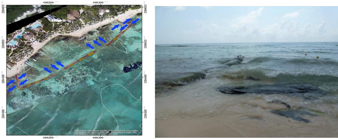
Figura 1. Bolsacretos instalados con anterioridad frente a la playa del Hotel Sandos Caracol Eco Resort.
