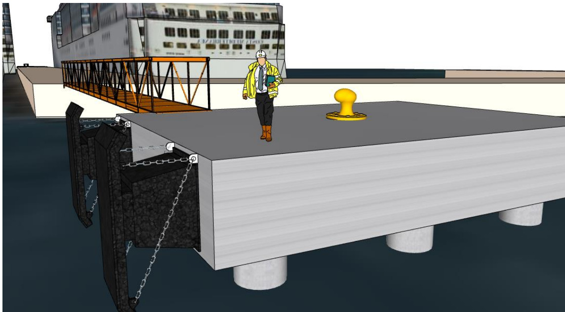
Figura II-6. Duque de alba y cruce tipo puente que conecta con el muelle.
