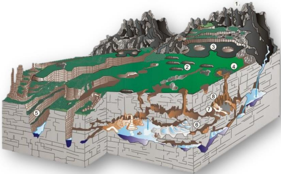
Figura 12. Modelo de un acuífero kárstico. 1.-Lapiaz, 2.- Dolina, 3.-Polje con sumidero, 4.-Sima, 5.-Cañón, 6.-Gours, 7.-Estalactita, 8.-Estalagmita. Fuente: Mateos y González (2009)
