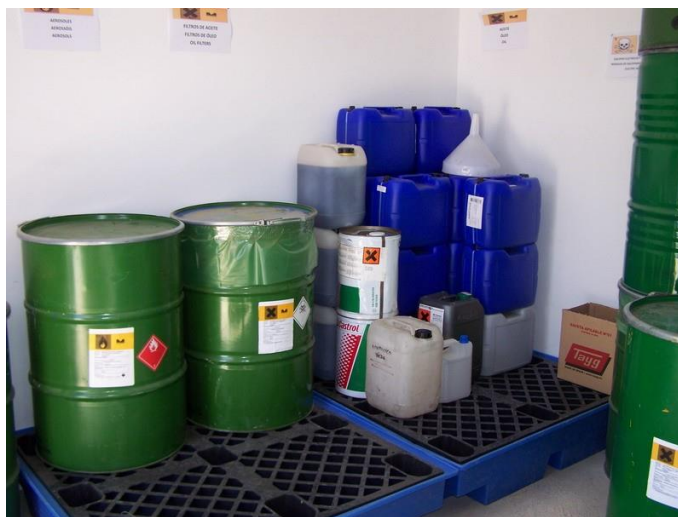
Figura 31. Ejemplificación de Almacén de Residuos Peligrosos
