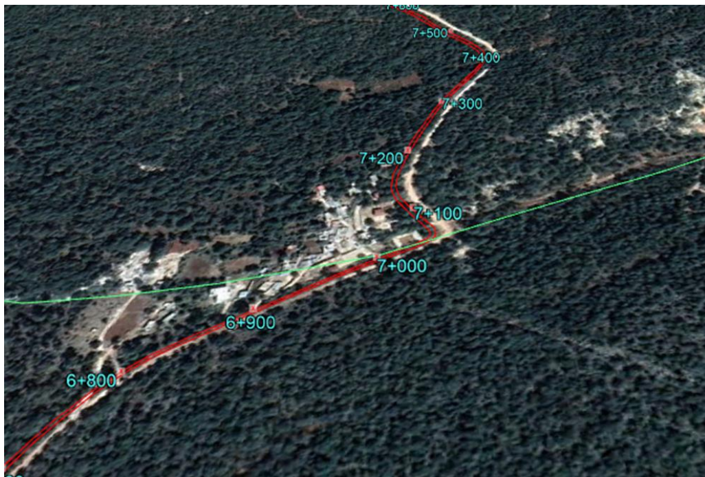
Figura 82. Imagen satelital del escurrimiento ubicado en el km 7+060 (línea verde) cruzando con el eje del camino (línea roja).
