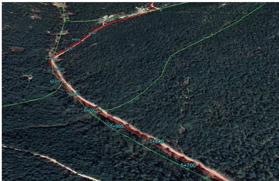
Figura 78. Imagen satelital del escurrimiento ubicado en el km 5+983 (línea verde) cruzando con el eje del camino (línea roja).
