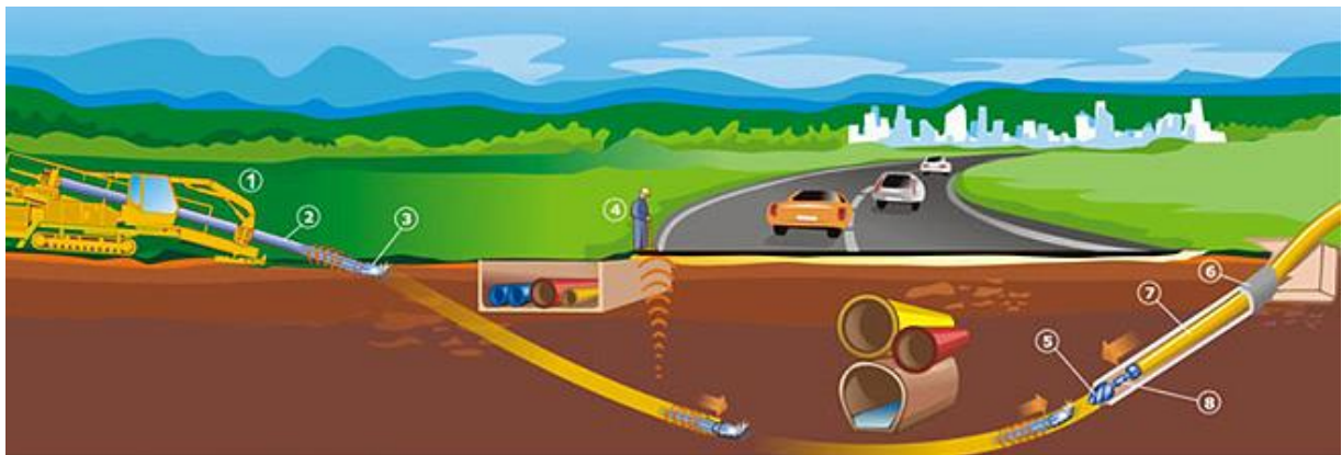
Figura 7. Esquema de la Perforación Horizontal Dirigida.
