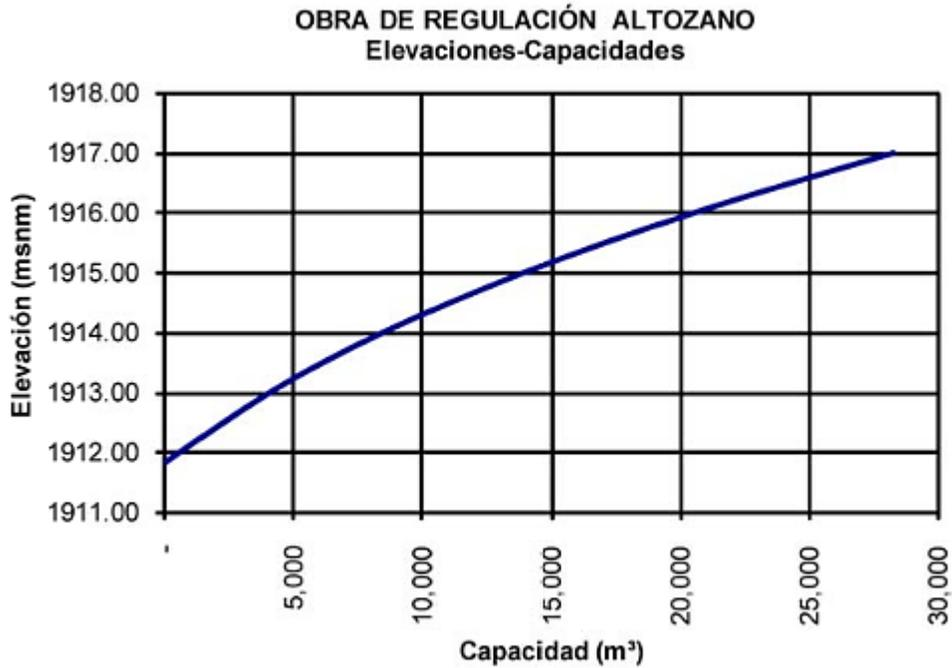
**Figura 33. Elevacion-Capacidad de la obra de regulación pluvial del proyecto Altozano**
