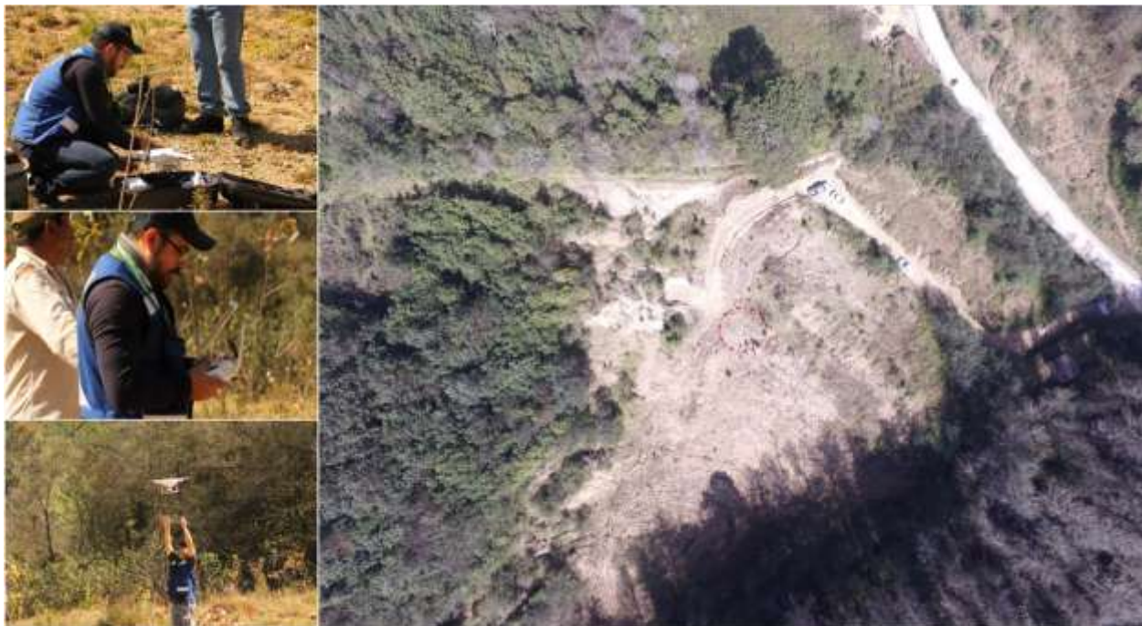
Imagen 13. Empleo de Drone DJI (Phantom 3 Advanced), las imágenes muestran la preparación del equipo, los sobrevuelos realizados dentro de la PPE, PPO y colindancias. En el punto de despegue se tomó una coordenada con la ayuda de un GPS y posteriormente se tomó una fotografía aérea con el Drone para tener una referencia espacial ubicando una diana de control.
