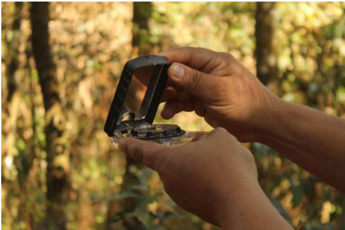
Imagen 16. Con la ayuda de una brújula se ubicó el Norte franco partiendo del centro marcado en cada sitio y posteriormente con la ayuda de una cinta métrica se delimito la parcela.
