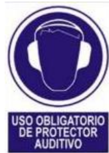
Figura VI. 6. Señal de uso obligatorio de protección auditiva.
