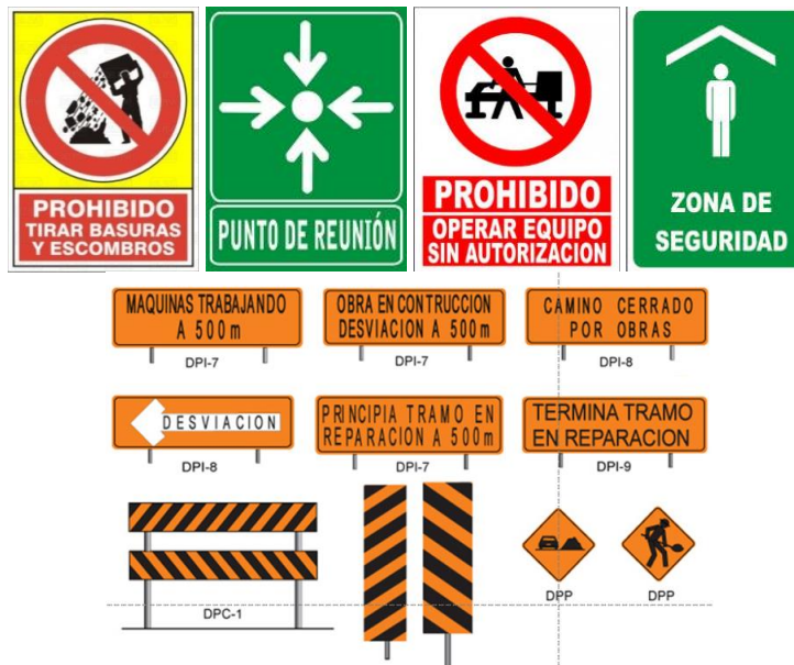
Figura VI. 4. Señales de seguridad en la construcción para evitar accidentes.
