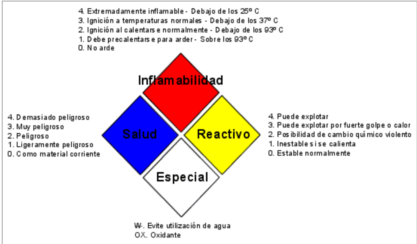
Imagen 26. Nivel de riesgo-rombo de seguridad
