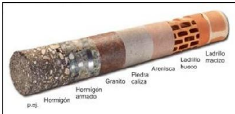
Imagen 11. Testigo producto de perforación con diamante
