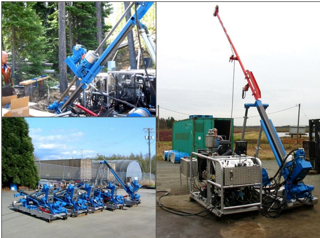
Imagen 8. Máquina de perforación HYDRACORE 2000
