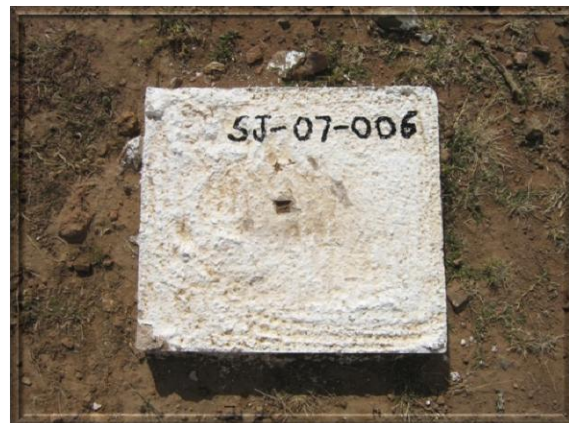
Imagen 25. Sellado de barreno (fotografía de archivo)
