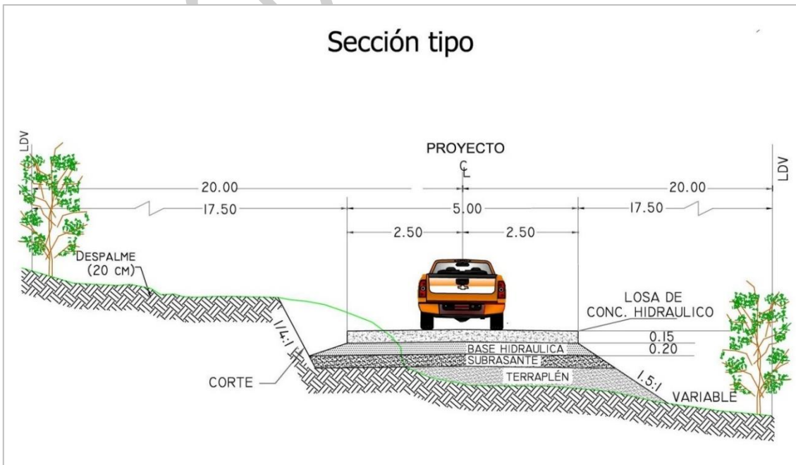
Figura 2-2 Sección tipo del camino
