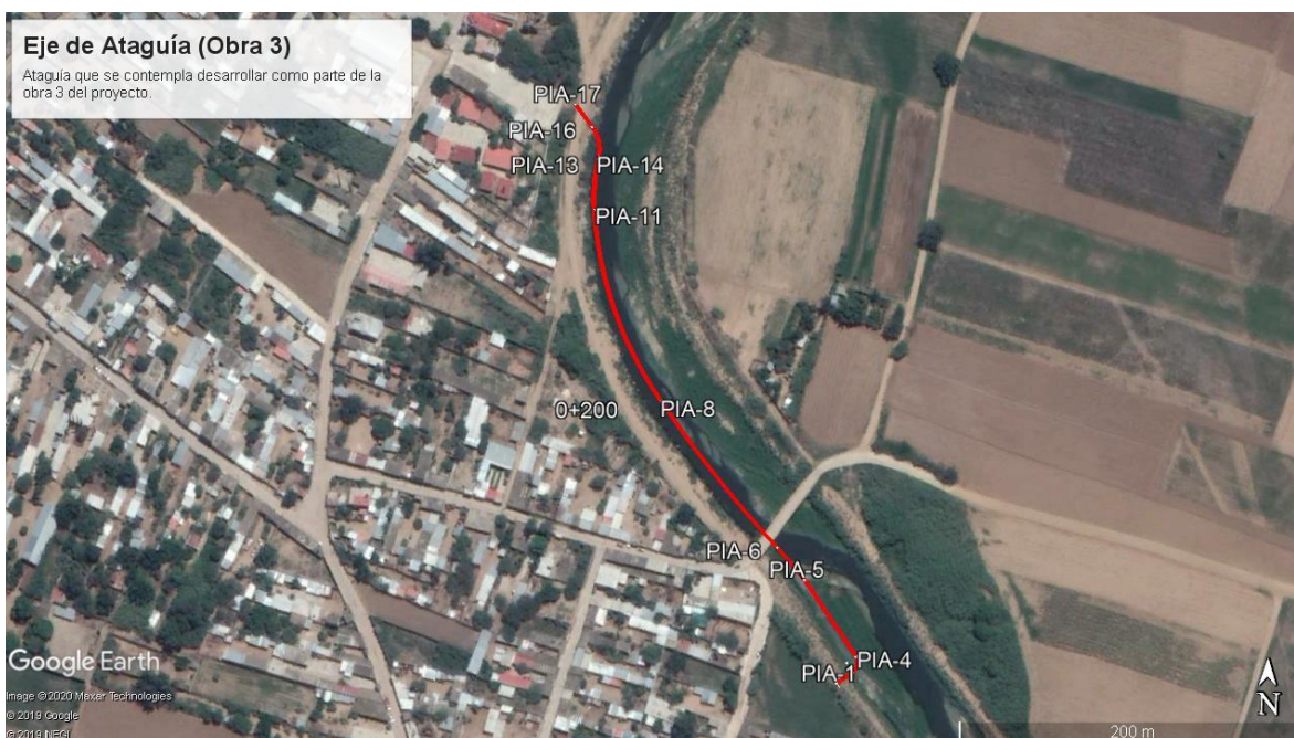
Ilustración 12. Sobreposición en imagen satelital del proyecto de ataguía de la obra 3 del proyecto.
