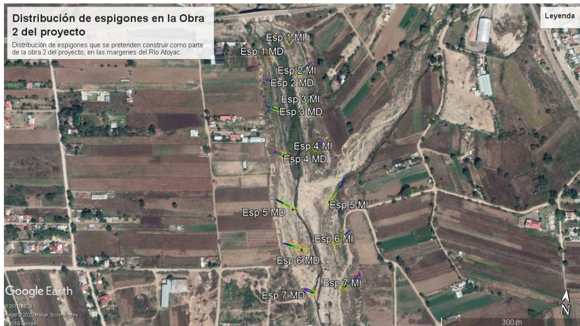
Ilustración 9. Sobreposición del proyecto de espigones que se pretenden desarrollar como parte del proyecto en la obra 2.
