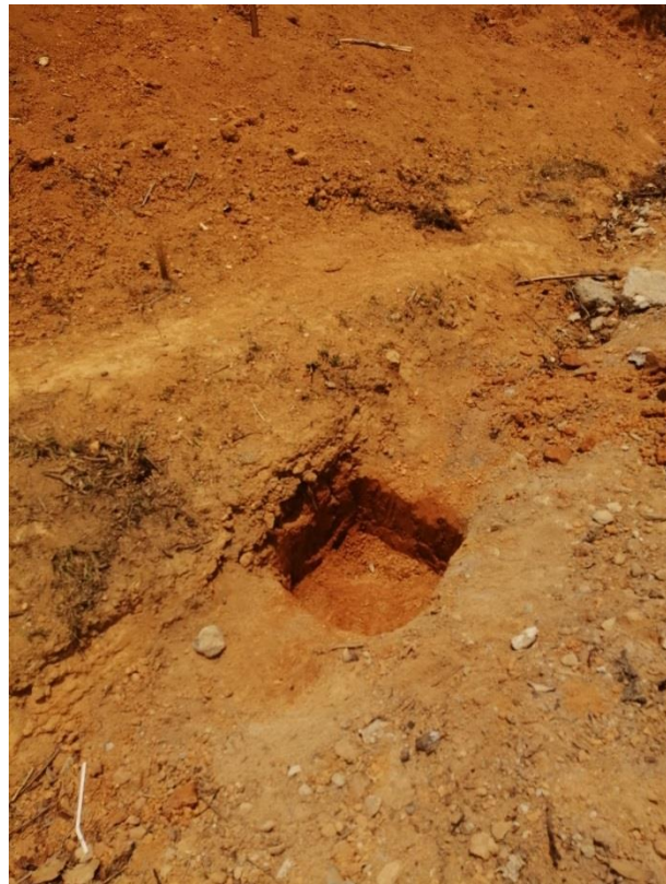
Foto 3. Evidencia del trabajo de mecánica de suelos en el tramo, se observa el tipo de arcilla rojizo.
