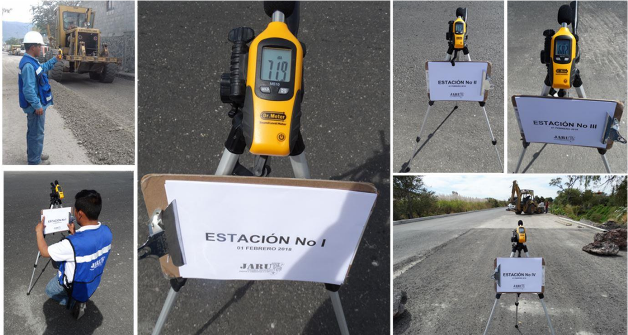
Figura II.12. Actividades de monitoreo de ruido durante los procesos de modernización de un camino en el estado de Morelos.
