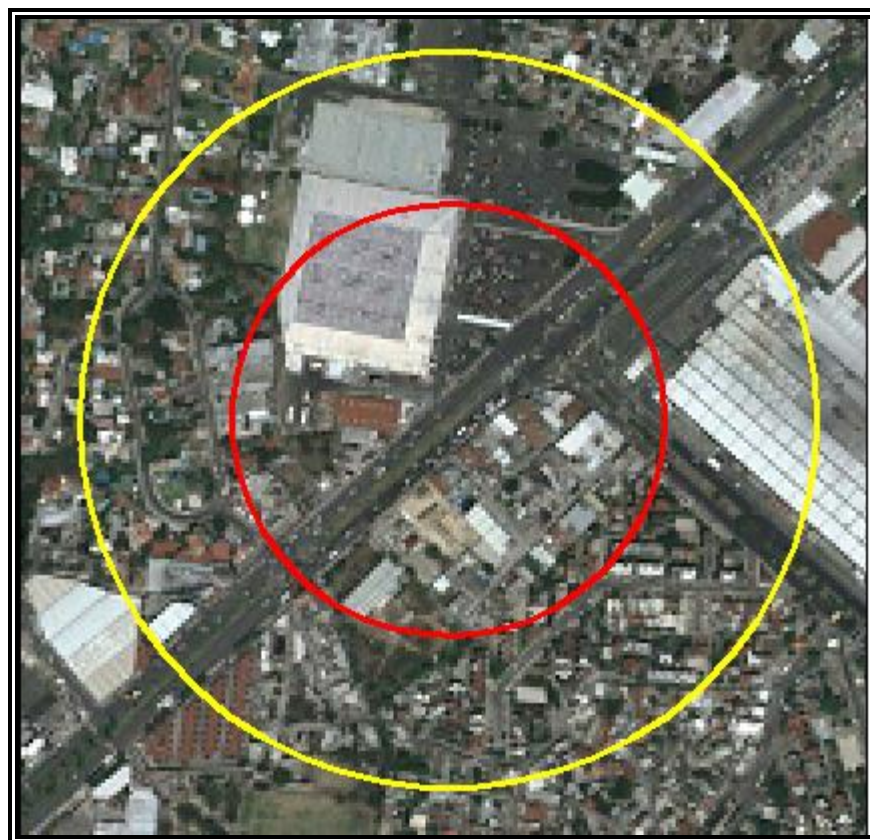
Figura VI.3.2.15 Evento 3.3 Explosión no Confinada (Sobrepresión). Zona de Alto Riesgo (ZAR) (1 PSI) en color rojo y Zona de Amortiguamiento (ZA) (0,5 PSI) en color amarillo.
