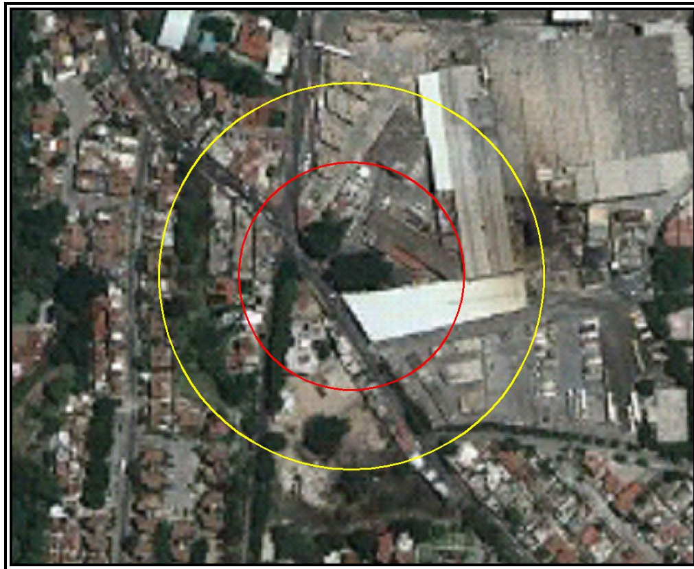
Figura VI.3.2.94 Evento 16.4 Explosión no Confinada (Sobrepresión). Zona de Alto Riesgo (ZAR) (1 PSI) en color rojo y Zona de Amortiguamiento (ZA) (0,5 PSI) en color amarillo.
