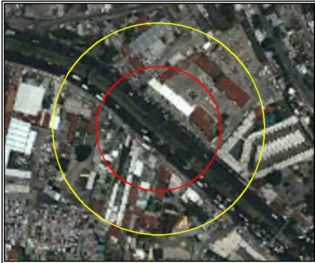
Figura VI.3.2.46 Evento 8.4 Explosión no Confinada (Sobrepresión). Zona de Alto Riesgo (ZAR) (1 PSI) en color rojo y Zona de Amortiguamiento (ZA) (0,5 PSI) en color amarillo.
