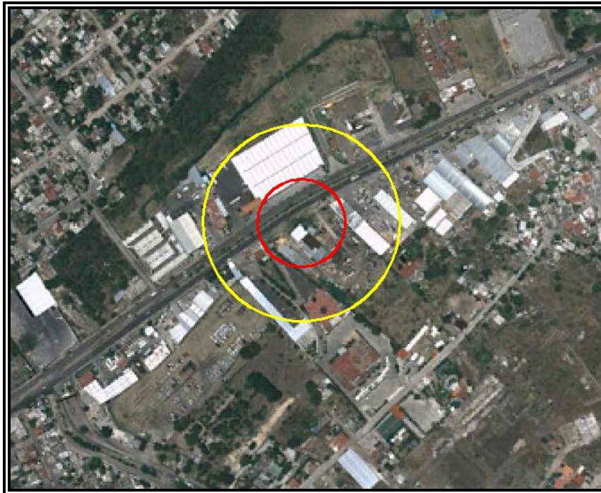
Figura VI.3.2.10 Evento 2.4 Explosión no Confinada (Sobrepresión). Zona de Alto Riesgo (ZAR) (1 PSI) en color rojo y Zona de Amortiguamiento (ZA) (0,5 PSI) en color amarillo.
