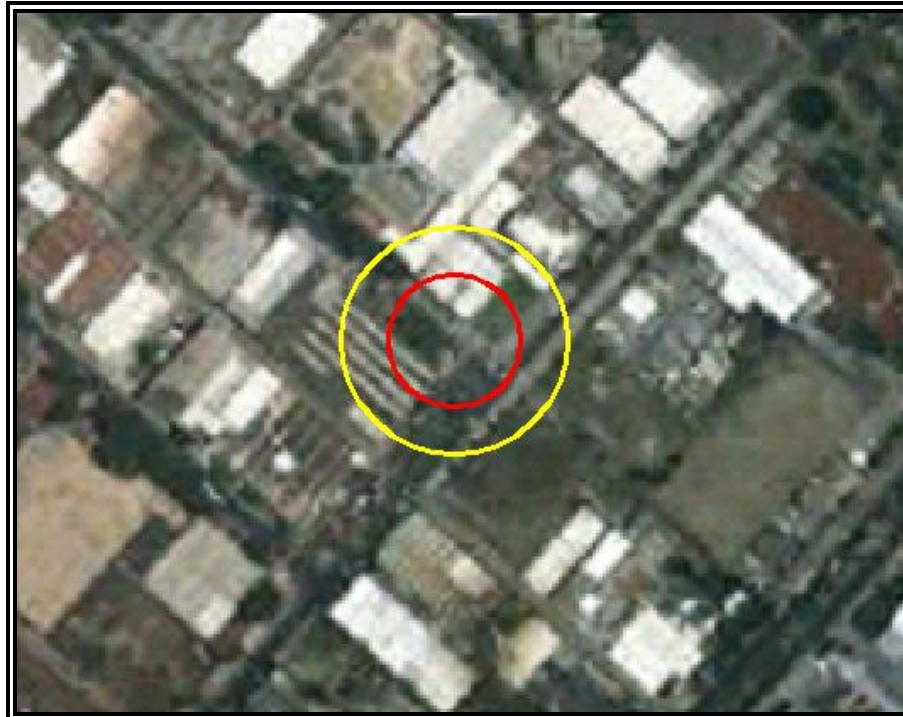
Figura VI.3.2.130 Evento 22.4 Explosión no Confinada (Sobrepresión). Zona de Alto Riesgo (ZAR) (1 PSI) en color rojo y Zona de Amortiguamiento (ZA) (0,5 PSI) en color amarillo.
