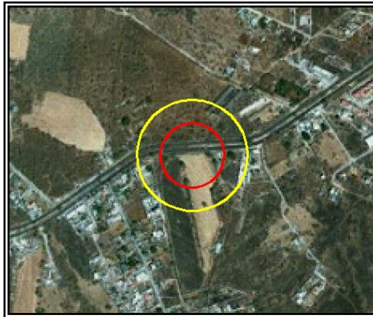
Figura VI.3.2.140 Evento 24.4 Explosión no Confinada (Sobrepresión). Zona de Alto Riesgo (ZAR) (1 PSI) en color rojo y Zona de Amortiguamiento (ZA) (0,5 PSI) en color amarillo.
