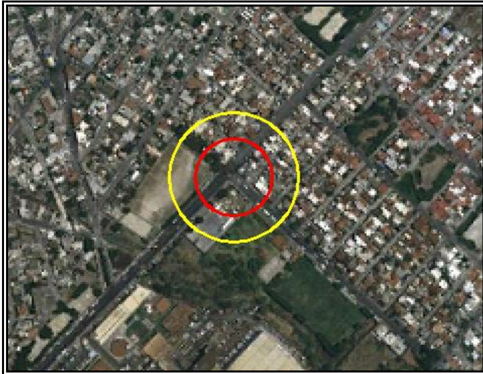
Figura VI.3.2.82 Evento 14.4 Explosión no Confinada (Sobrepresión). Zona de Alto Riesgo (ZAR) (1 PSI) en color rojo y Zona de Amortiguamiento (ZA) (0,5 PSI) en color amarillo.
