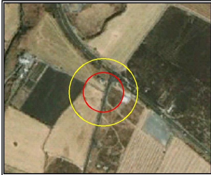
Figura VI.3.2.178 Evento 30.4 Explosión no Confinada (Sobrepresión). Zona de Alto Riesgo (ZAR) (1 PSI) en color rojo y Zona de Amortiguamiento (ZA) (0,5 PSI) en color amarillo.
