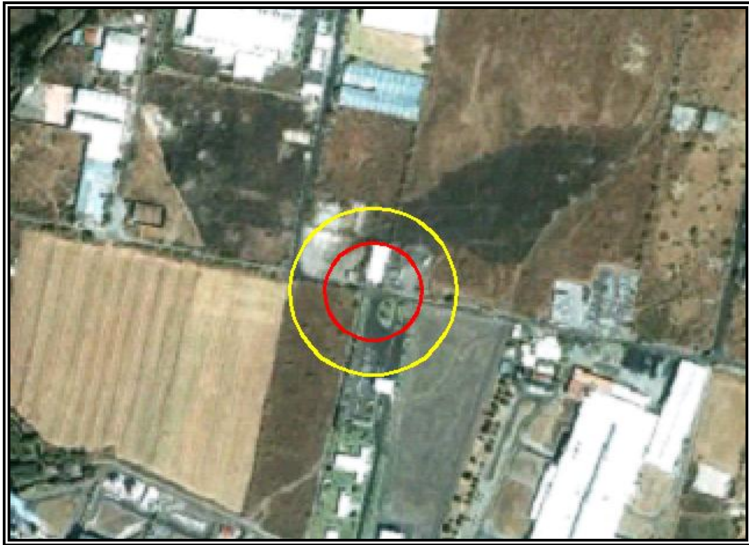
Figura VI.3.2.184 Evento 31.4 Explosión no Confinada (Sobrepresión). Zona de Alto Riesgo (ZAR) (1 PSI) en color rojo y Zona de Amortiguamiento (ZA) (0,5 PSI) en color amarillo.
