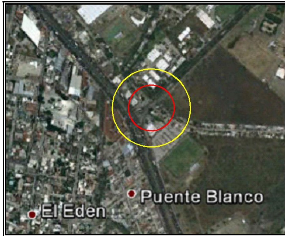
Figura VI.3.2.118 Evento 19.4 Explosión no Confinada (Sobrepresión). Zona de Alto Riesgo (ZAR) (1 PSI) en color rojo y Zona de Amortiguamiento (ZA) (0,5 PSI) en color amarillo.
