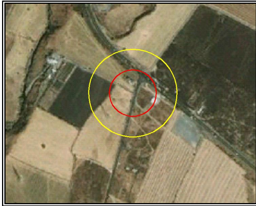
Figura VI.3.2.175 Evento 30.1 Incendio (Radiación Térmica). Zona de Alto Riesgo (ZAR) (5 KW/m 2 ) en color rojo y Zona de Amortiguamiento (ZA) (1.4 KW/m 2 ) en color amarillo.
