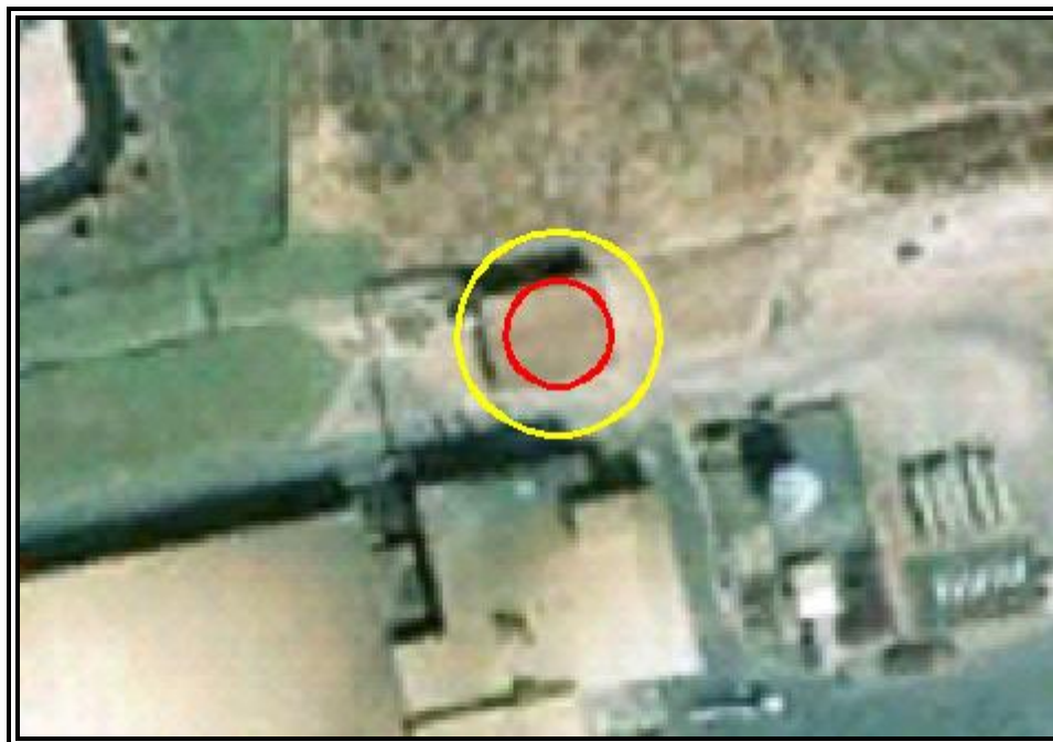
Figura VI.3.2.61 Evento 11.1 Incendio (Radiación Térmica). Zona de Alto Riesgo (ZAR) (5 KW/m 2 ) en color rojo y Zona de Amortiguamiento (ZA) (1.4 KW/m 2 ) en color amarillo.
