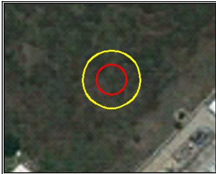
Figura VI.3.2.73 Evento 13.1 Incendio (Radiación Térmica). Zona de Alto Riesgo (ZAR) ( 5 \text{ KW/m}^2 ) en color rojo y Zona de Amortiguamiento (ZA) ( 1.4 \text{ KW/m}^2 ) en color amarillo.
