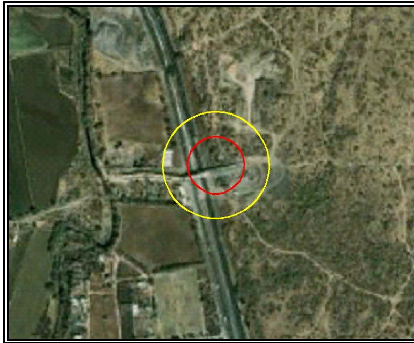
Figura VI.3.2.163 Evento 28.1 Incendio (Radiación Térmica). Zona de Alto Riesgo (ZAR) (5 \text{KW/m}^2 ) en color rojo y Zona de Amortiguamiento (ZA) (1.4 \text{KW/m}^2 ) en color amarillo.
