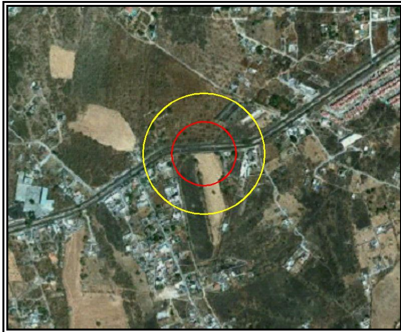
Figura VI.3.2.139 Evento 24.1 Incendio (Radiación Térmica). Zona de Alto Riesgo (ZAR) (5 KW/m 2 ) en color rojo y Zona de Amortiguamiento (ZA) (1.4 KW/m 2 ) en color amarillo.
