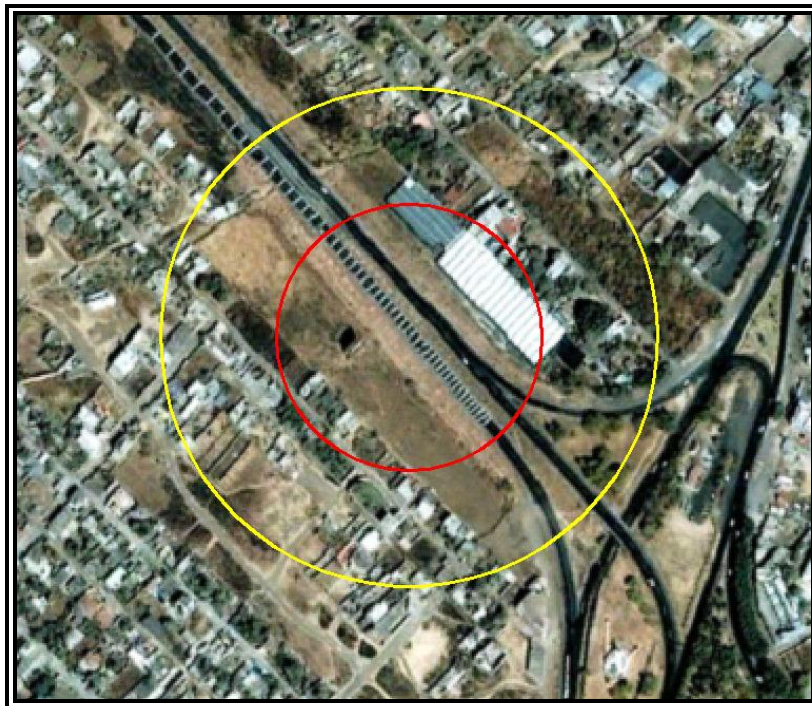
Figura VI.3.2.217 Evento 37.1 Incendio (Radiación Térmica). Zona de Alto Riesgo (ZAR) (5 KW/m 2 ) en color rojo y Zona de Amortiguamiento (ZA) (1.4 KW/m 2 ) en color amarillo.
