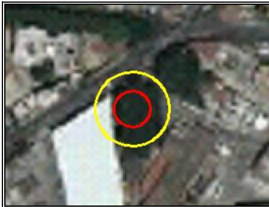
Figura VI.3.2.92 Evento 16.2 Incendio (Radiación Térmica). Zona de Alto Riesgo (ZAR) (5 KW/m 2 )
