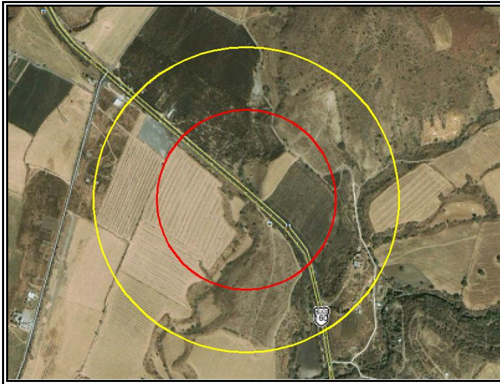
Figura VI.3.2.3 Evento 1.3 Explosión no Confinada (Sobrepresión). Zona de Alto Riesgo (ZAR) (1 PSI) en color rojo y Zona de Amortiguamiento (ZA) (0,5 PSI) en color amarillo.
