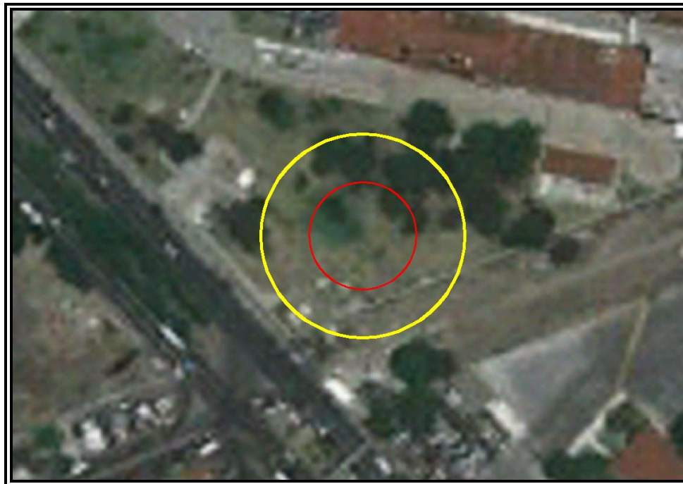
Figura VI.3.2.20 Evento 4.2 Incendio (Radiación Térmica). Zona de Alto Riesgo (ZAR) (5 KW/m 2 ) en color rojo y Zona de Amortiguamiento (ZA) (1.4 KW/m 2 ) en color amarillo.
