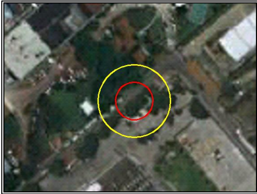
Figura VI.3.2.338 Evento 7.2 Incendio (Radiación Térmica). Zona de Alto Riesgo (ZAR) ( 5 \text{ KW/m}^2 ) en color rojo y Zona de Amortiguamiento (ZA) ( 1.4 \text{ KW/m}^2 ) en color amarillo.
