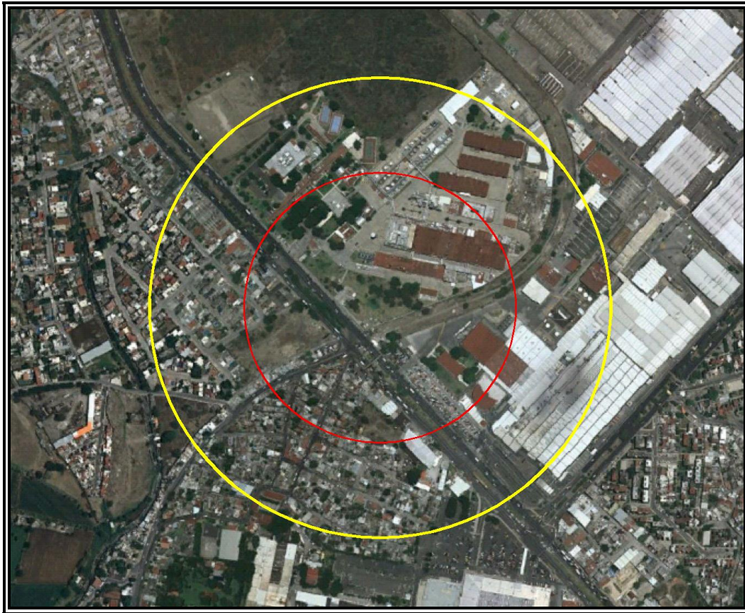
Figura VI.3.2.21 Evento 4.3 Explosión no Confinada (Sobrepresión). Zona de Alto Riesgo (ZAR) (1 PSI) en color rojo y Zona de Amortiguamiento (ZA) (0,5 PSI) en color amarillo.
