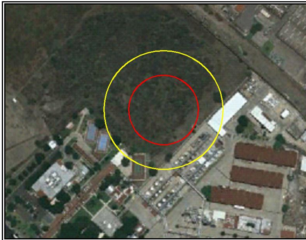
Figura VI.3.2.76 Evento 13.4 Explosión no Confinada (Sobrepresión). Zona de Alto Riesgo (ZAR) (1 PSI) en color rojo y Zona de Amortiguamiento (ZA) (0,5 PSI) en color amarillo.
