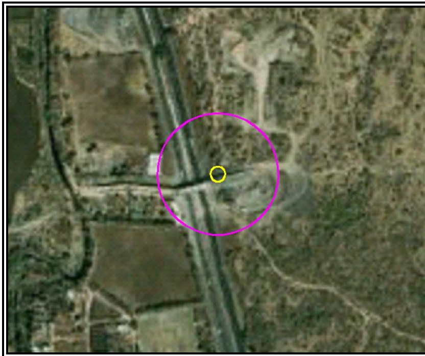
Figura VI.3.2.167 Evento 28.5. Radios de concentraciones de Gas Natural en partes por millón (ppm).
