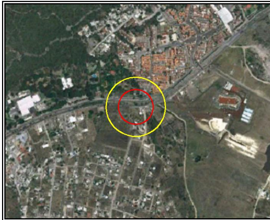
Figura VI.3.2.202 Evento 34.4 Explosión no Confinada (Sobrepresión). Zona de Alto Riesgo (ZAR) (1 PSI) en color rojo y Zona de Amortiguamiento (ZA) (0,5 PSI) en color amarillo.
