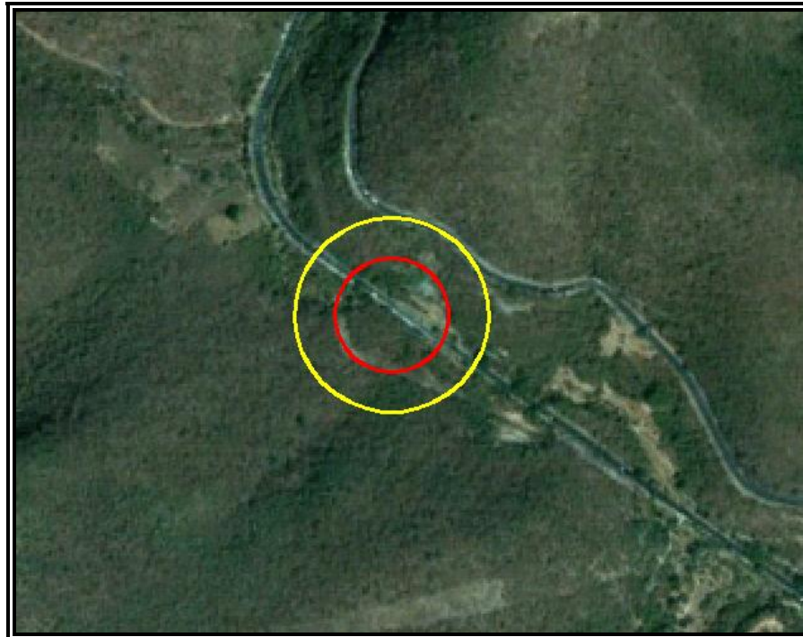
Figura VI.3.2.208 Evento 35.4 Explosión no Confinada (Sobrepresión). Zona de Alto Riesgo (ZAR) (1 PSI) en color rojo y Zona de Amortiguamiento (ZA) (0,5 PSI) en color amarillo.
