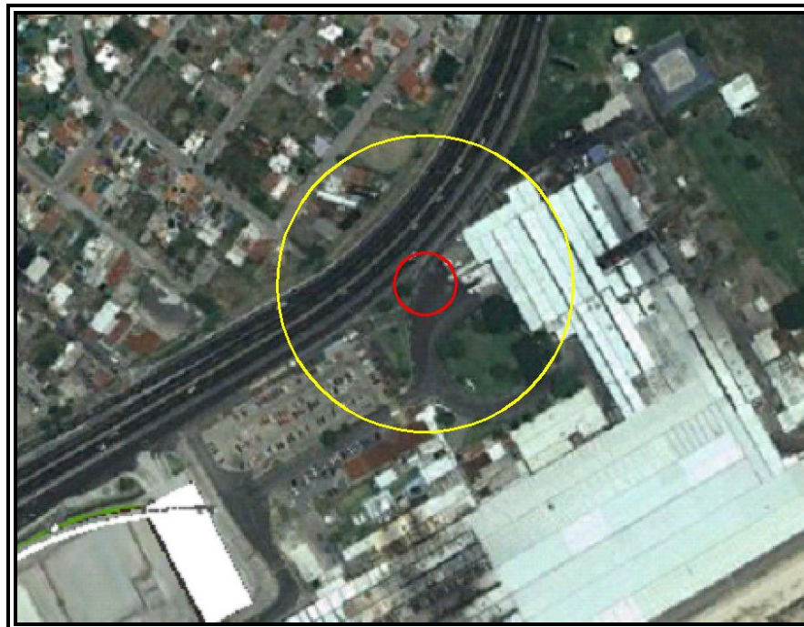
Figura VI.3.2.98 Evento 17.2 Incendio (Radiación Térmica). Zona de Alto Riesgo (ZAR) ( 5 \text{ KW/m}^2 ) en color rojo y Zona de Amortiguamiento (ZA) ( 1.4 \text{ KW/m}^2 ) en color amarillo.
