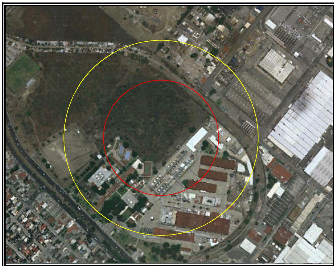
Figura VI.3.2.75 Evento 13.3 Explosión no Confinada (Sobrepresión). Zona de Alto Riesgo (ZAR) (1 PSI) en color rojo y Zona de Amortiguamiento (ZA) (0,5 PSI) en color amarillo.
