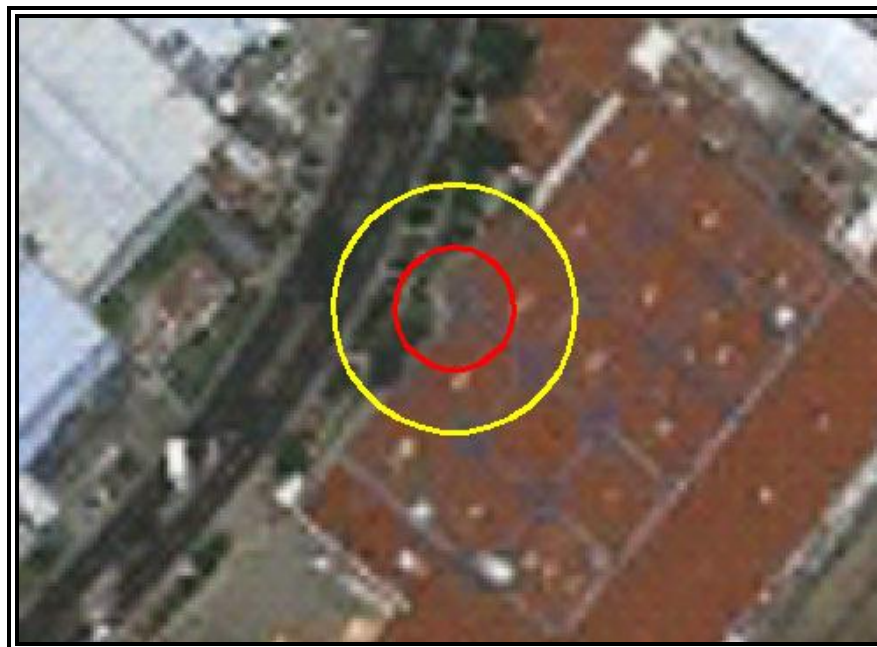
Figura VI.3.2.50 Evento 9.2 Incendio (Radiación Térmica). Zona de Alto Riesgo (ZAR) (5 KW/m 2 )
