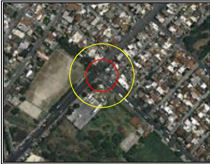
Figura VI.3.2.79 Evento 14.1 Incendio (Radiación Térmica). Zona de Alto Riesgo (ZAR) ( 5 \text{ KW/m}^2 ) en color rojo y Zona de Amortiguamiento (ZA) ( 1.4 \text{ KW/m}^2 ) en color amarillo.
