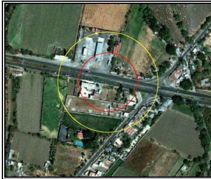
Figura VI.3.2.214 Evento 36.4 Explosión no Confinada (Sobrepresión). Zona de Alto Riesgo (ZAR) (1 PSI) en color rojo y Zona de Amortiguamiento (ZA) (0,5 PSI) en color amarillo.
