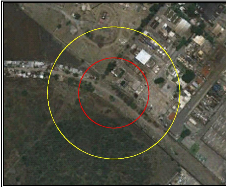
Figura VI.3.2.31 Evento 6.1 Incendio (Radiación Térmica). Zona de Alto Riesgo (ZAR) ( 5 \text{ KW/m}^2 ) en color rojo y Zona de Amortiguamiento (ZA) ( 1.4 \text{ KW/m}^2 ) en color amarillo.
