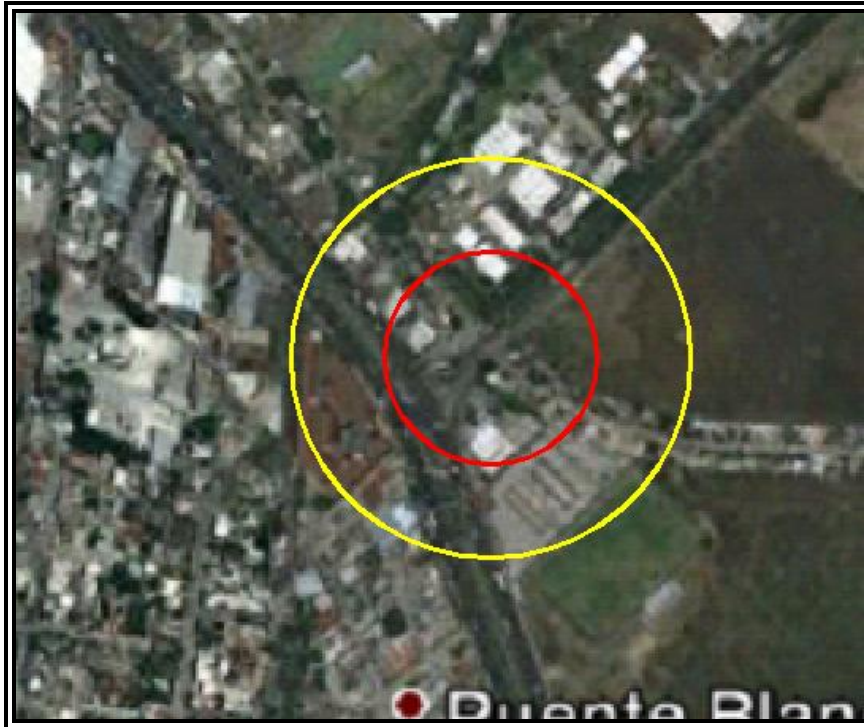
Figura VI.3.2.115 Evento 20.1 Incendio (Radiación Térmica). Zona de Alto Riesgo (ZAR) (5 \text{KW/m}^2 ) en color rojo y Zona de Amortiguamiento (ZA) (1.4 \text{KW/m}^2 ) en color amarillo.
