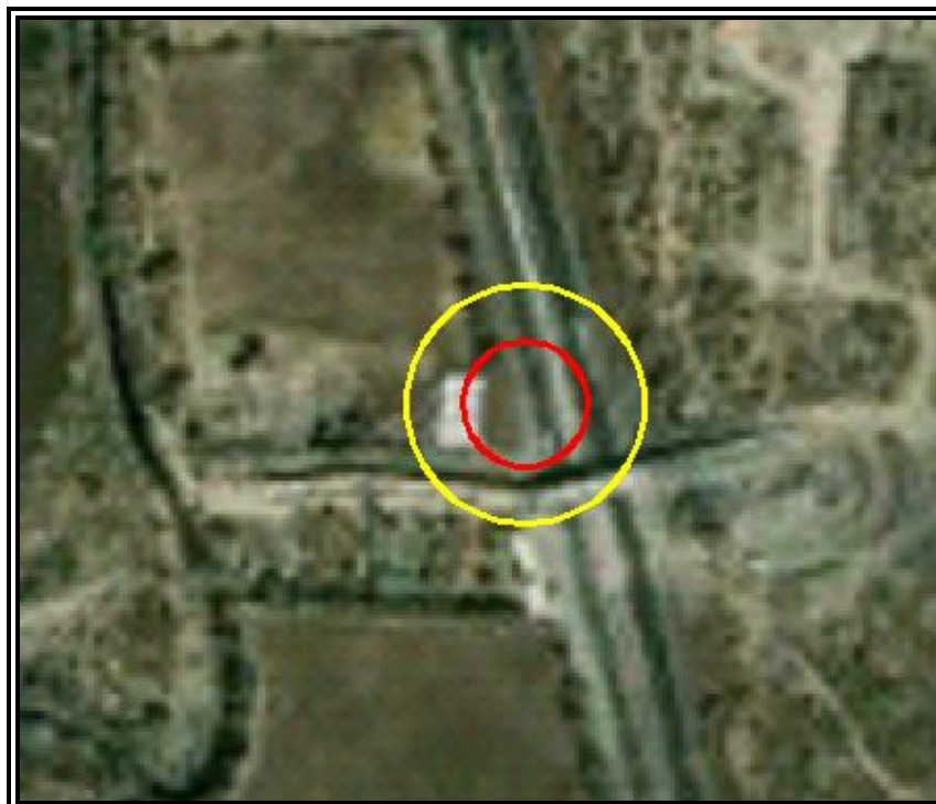
Figura VI.3.2.158 Evento 27.2 Incendio (Radiación Térmica). Zona de Alto Riesgo (ZAR) (5 KW/m 2 ) en color rojo y Zona de Amortiguamiento (ZA) (1.4 KW/m 2 ) en color amarillo.
