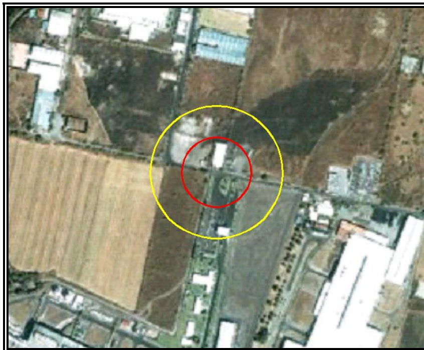
Figura VI.3.2.181 Evento 31.1 Incendio (Radiación Térmica). Zona de Alto Riesgo (ZAR) (5 KW/m 2 ) en color rojo y Zona de Amortiguamiento (ZA) (1.4 KW/m 2 ) en color amarillo.
