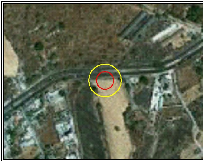
Figura VI.3.2.140 Evento 24.2 Incendio (Radiación Térmica). Zona de Alto Riesgo (ZAR) (5 KW/m 2 ) en color rojo y Zona de Amortiguamiento (ZA) (1.4 KW/m 2 ) en color amarillo.
