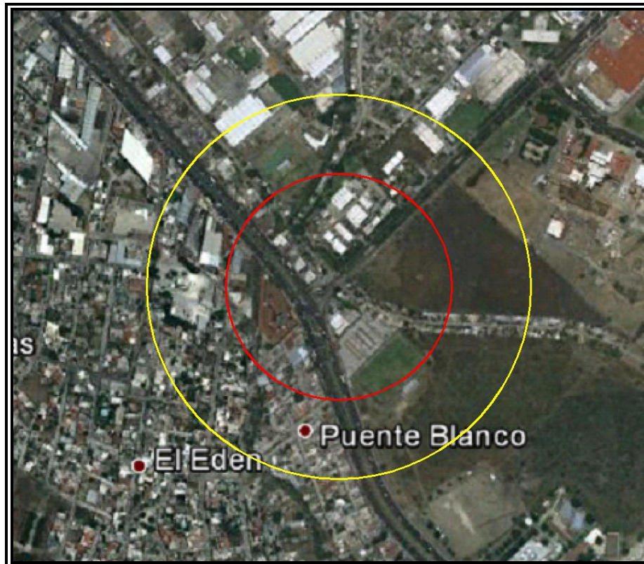
Figura VI.3.2.117 Evento 19.3 Explosión no Confinada (Sobrepresión). Zona de Alto Riesgo (ZAR) (1 PSI) en color rojo y Zona de Amortiguamiento (ZA) (0,5 PSI) en color amarillo.
