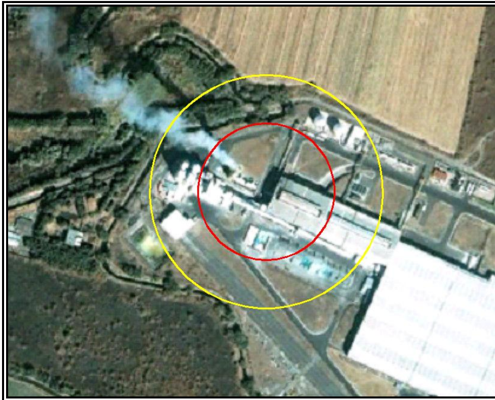
Figura VI.3.2.28 Evento 5.4 Explosión no Confinada (Sobrepresión). Zona de Alto Riesgo (ZAR) (1 PSI) en color rojo y Zona de Amortiguamiento (ZA) (0,5 PSI) en color amarillo.
