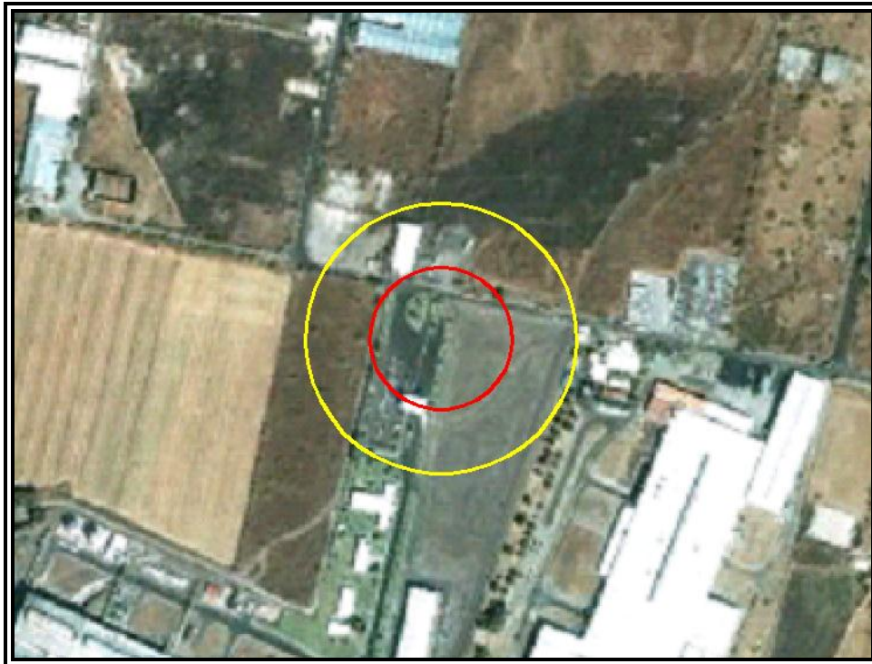
Figura VI.3.2.187 Evento 32.1 Incendio (Radiación Térmica). Zona de Alto Riesgo (ZAR) (5 KW/m 2 ) en color rojo y Zona de Amortiguamiento (ZA) (1.4 KW/m 2 ) en color amarillo.
