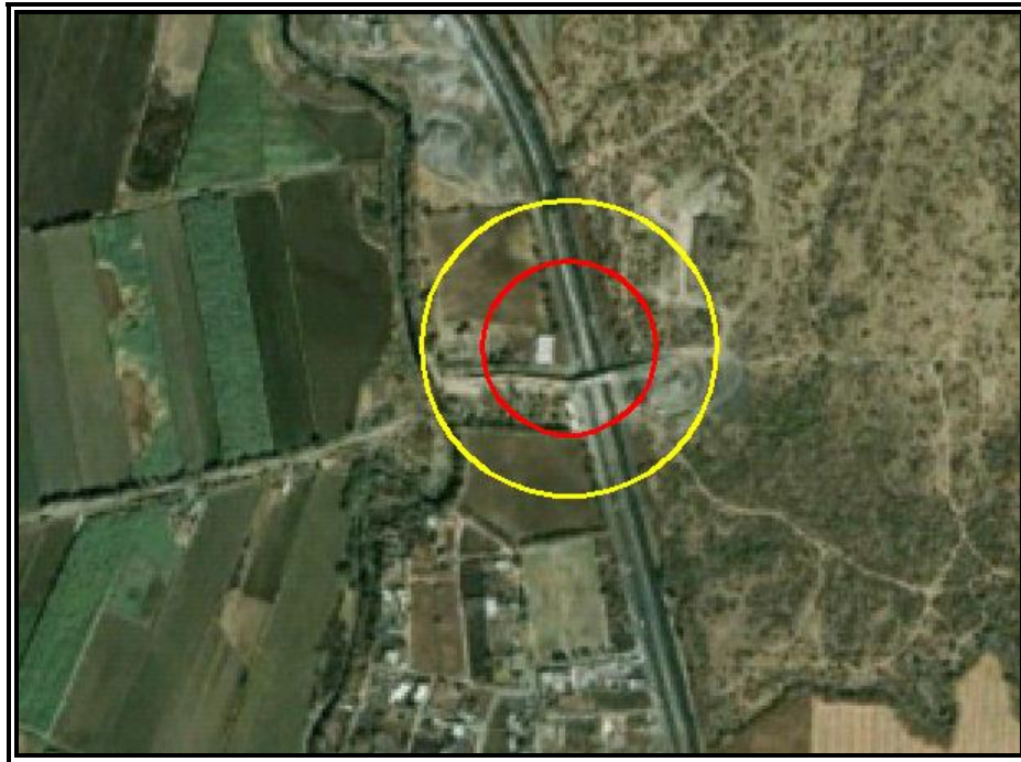
Figura VI.3.2.160 Evento 27.4 Explosión no Confinada (Sobrepresión). Zona de Alto Riesgo (ZAR) (1 PSI) en color rojo y Zona de Amortiguamiento (ZA) (0,5 PSI) en color amarillo.
