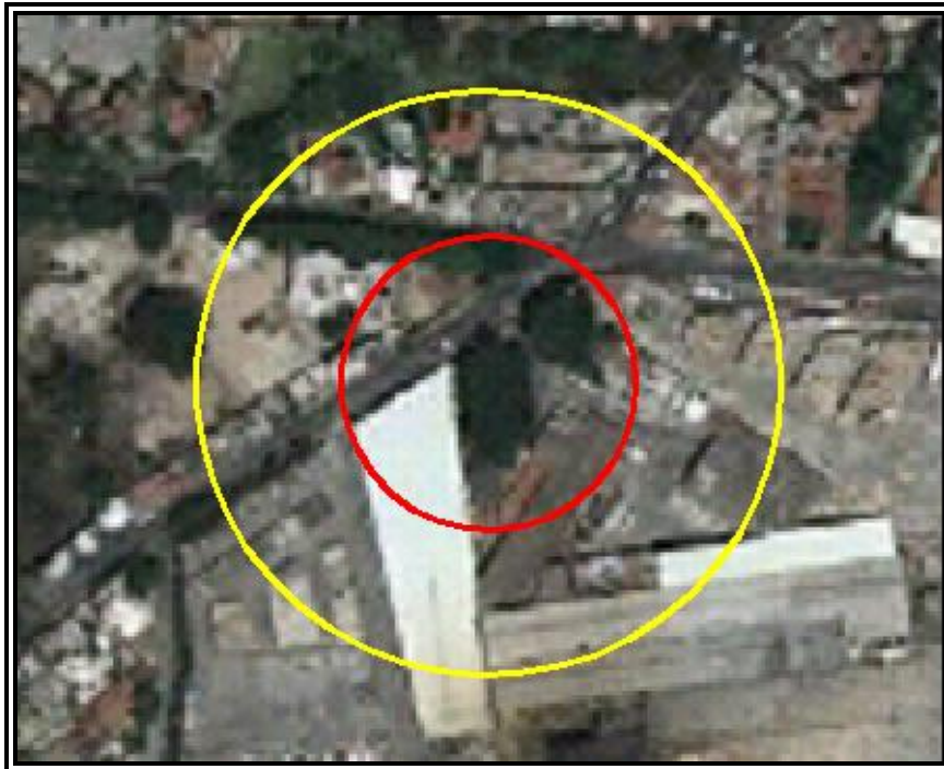
Figura VI.3.2.91 Evento 16.1 Incendio (Radiación Térmica). Zona de Alto Riesgo (ZAR) (5 KW/m 2 ) en color rojo y Zona de Amortiguamiento (ZA) (1.4 KW/m 2 ) en color amarillo.
