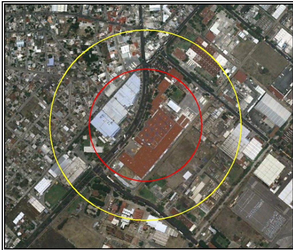
Figura VI.3.2.51 Evento 9.3 Explosión no Confinada (Sobrepresión). Zona de Alto Riesgo (ZAR) (1 PSI) en color rojo y Zona de Amortiguamiento (ZA) (0,5 PSI) en color amarillo.
