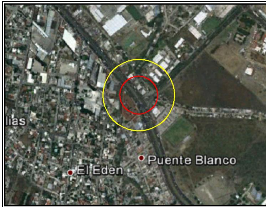
Figura VI.3.2.113 Evento 19.1 Incendio (Radiación Térmica). Zona de Alto Riesgo (ZAR) (5 KW/m 2 ) en color rojo y Zona de Amortiguamiento (ZA) (1.4 KW/m 2 ) en color amarillo.
