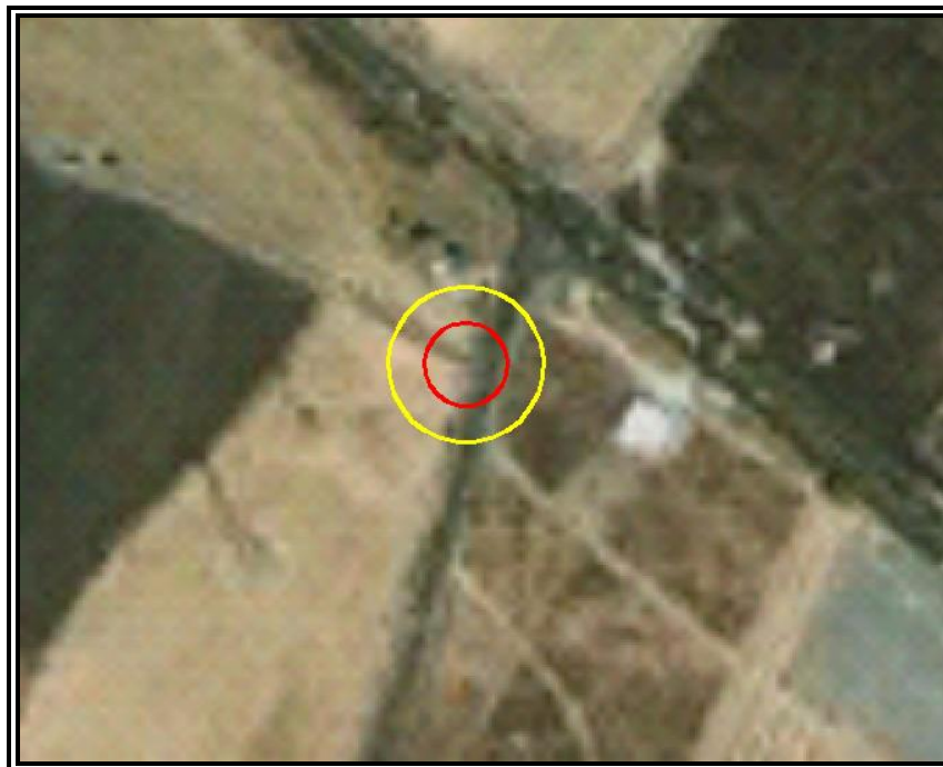
Figura VI.3.2.175 Evento 30.1 Incendio (Radiación Térmica). Zona de Alto Riesgo (ZAR) (5 KW/m 2 ) en color rojo y Zona de Amortiguamiento (ZA) (1.4 KW/m 2 ) en color amarillo.
