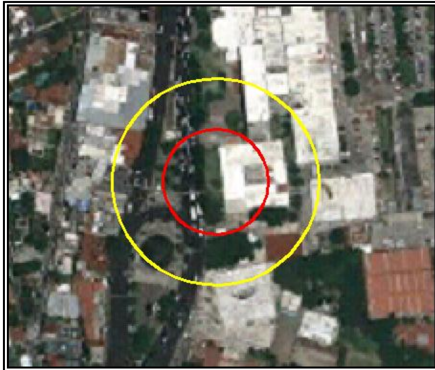
Figura VI.3.2.85 Evento 15.1 Incendio (Radiación Térmica). Zona de Alto Riesgo (ZAR) (5 KW/m 2 ) en color rojo y Zona de Amortiguamiento (ZA) (1.4 KW/m 2 ) en color amarillo.
