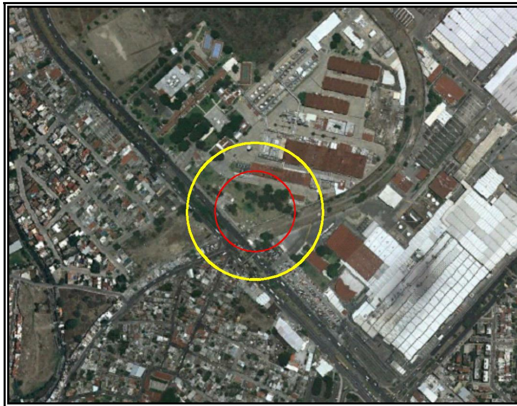
Figura VI.3.2.22 Evento 4.4 Explosión no Confinada (Sobrepresión). Zona de Alto Riesgo (ZAR) (1 PSI) en color rojo y Zona de Amortiguamiento (ZA) (0,5 PSI) en color amarillo.
