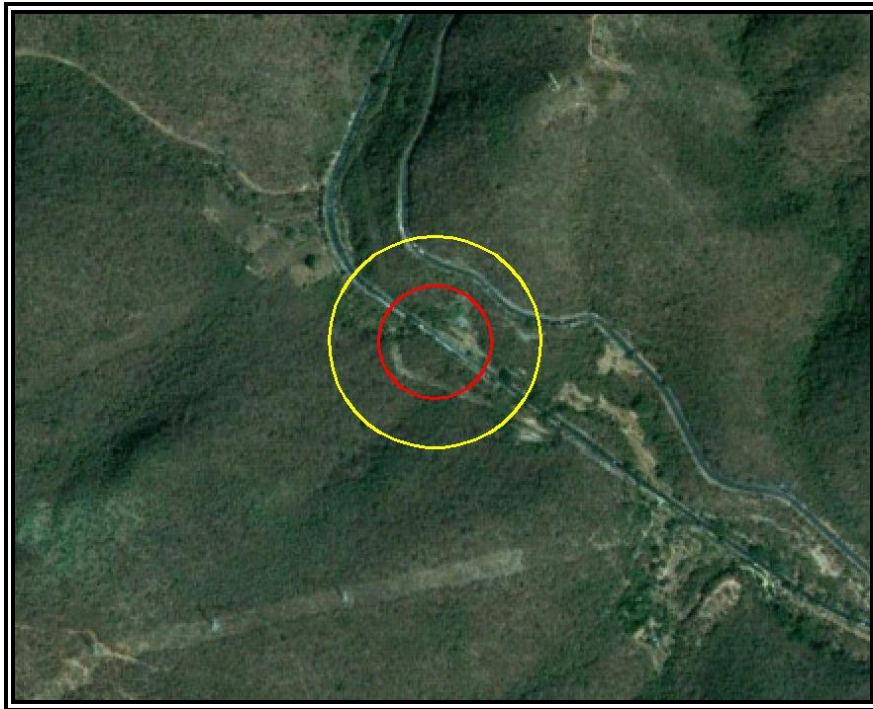
Figura VI.3.2.205 Evento 35.1 Incendio (Radiación Térmica). Zona de Alto Riesgo (ZAR) (5 KW/m 2 ) en color rojo y Zona de Amortiguamiento (ZA) (1.4 KW/m 2 ) en color amarillo.
