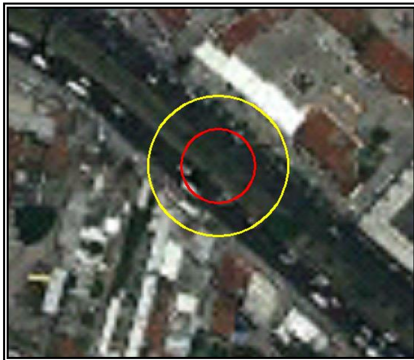
Figura VI.3.2.43 Evento 8.1 Incendio (Radiación Térmica). Zona de Alto Riesgo (ZAR) (5 KW/m 2 ) en color rojo y Zona de Amortiguamiento (ZA) (1.4 KW/m 2 ) en color amarillo.
