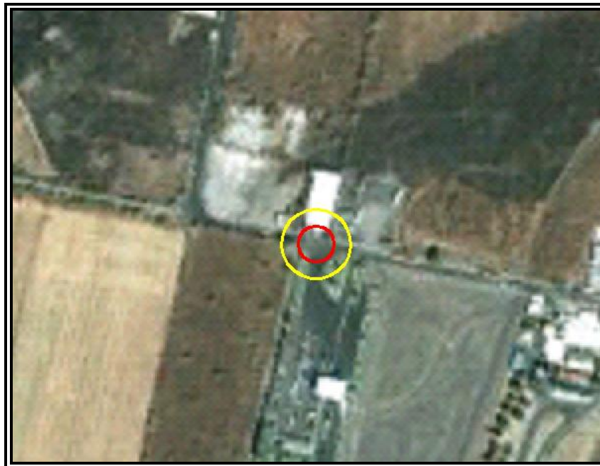
Figura VI.3.2.182 Evento 31.2 Incendio (Radiación Térmica). Zona de Alto Riesgo (ZAR) (5 KW/m 2 ) en color rojo y Zona de Amortiguamiento (ZA) (1.4 KW/m 2 ) en color amarillo.
