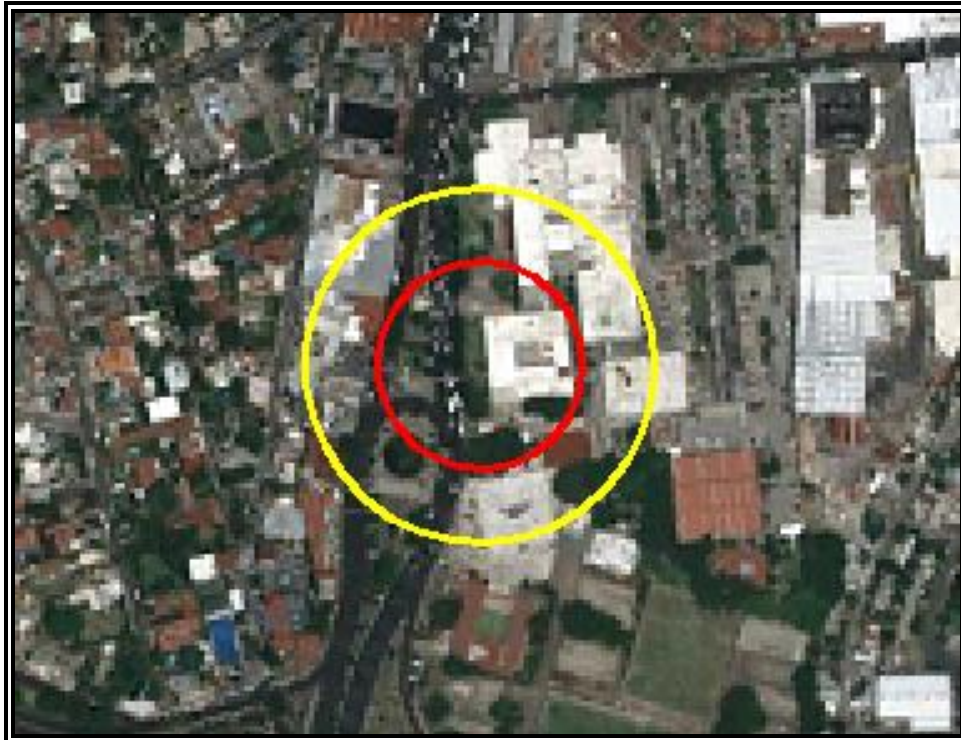
Figura VI.3.2.88 Evento 15.4 Explosión no Confinada (Sobrepresión). Zona de Alto Riesgo (ZAR) (1 PSI) en color rojo y Zona de Amortiguamiento (ZA) (0,5 PSI) en color amarillo.
