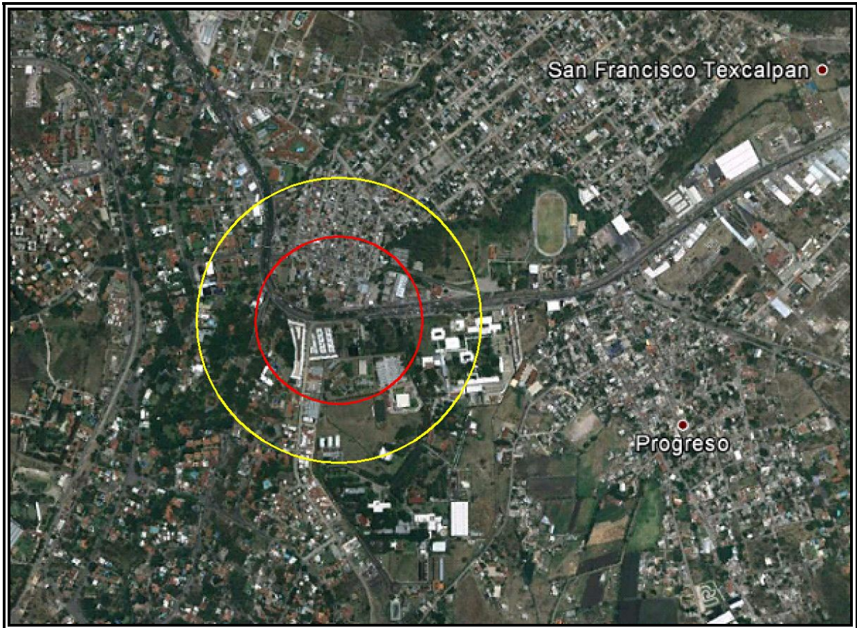
Figura VI.3.2.195 Evento 33.3 Explosión no Confinada (Sobrepresión). Zona de Alto Riesgo (ZAR) (1 PSI) en color rojo y Zona de Amortiguamiento (ZA) (0,5 PSI) en color amarillo.
