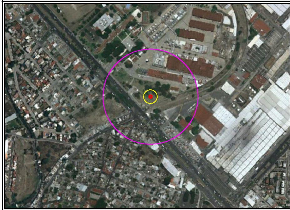
Figura VI.3.2.23 Evento 4.5. Radios de concentraciones de Gas Natural en partes por millón (ppm).
