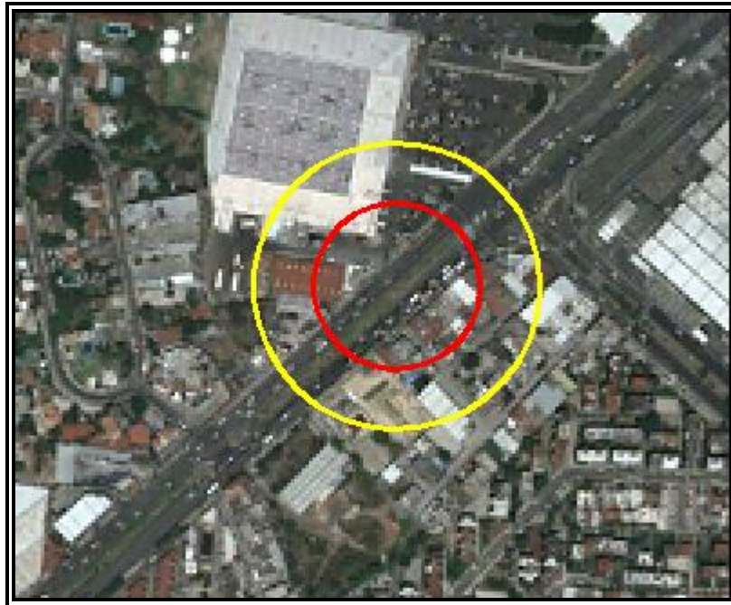
Figura VI.3.2.16 Evento 3.4 Explosión no Confinada (Sobrepresión). Zona de Alto Riesgo (ZAR) (1 PSI) en color rojo y Zona de Amortiguamiento (ZA) (0,5 PSI) en color amarillo.
