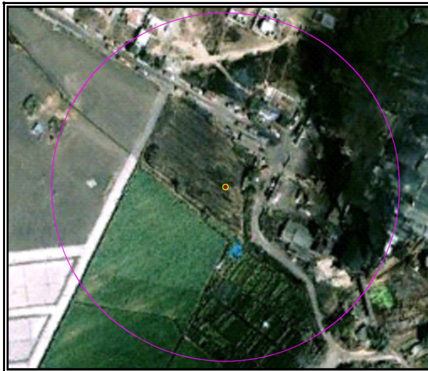
Figura VI.3.2.60 Evento 10.6. Radios de concentraciones de Gas Natural en partes por millón (ppm).
