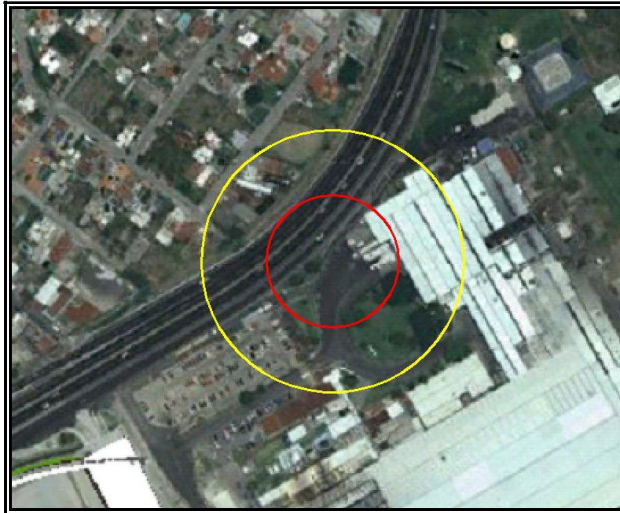
Figura VI.3.2.97 Evento 17.1 Incendio (Radiación Térmica). Zona de Alto Riesgo (ZAR) ( 5 \text{ KW/m}^2 ) en color rojo y Zona de Amortiguamiento (ZA) ( 1.4 \text{ KW/m}^2 ) en color amarillo.
