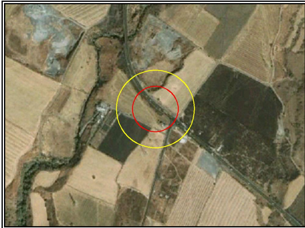
Figura VI.3.2.172 Evento 29.4 Explosión no Confinada (Sobrepresión). Zona de Alto Riesgo (ZAR) (1 PSI) en color rojo y Zona de Amortiguamiento (ZA) (0,5 PSI) en color amarillo.
