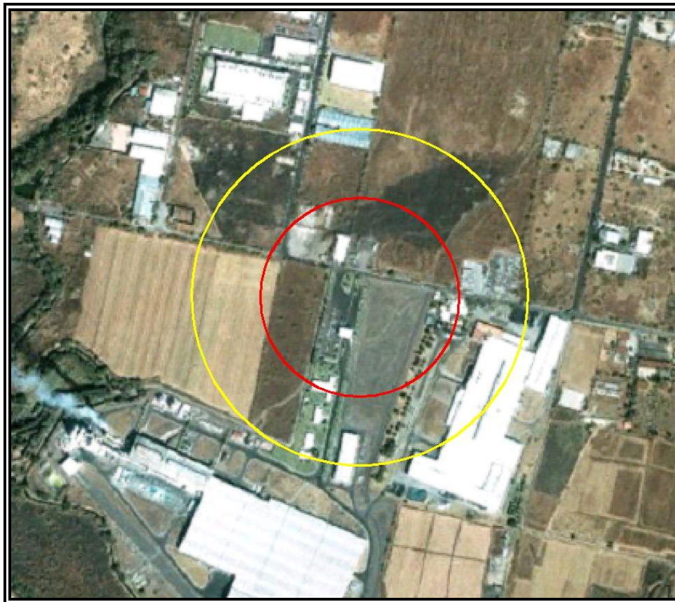
Figura VI.3.2.189 Evento 32.3 Explosión no Confinada (Sobrepresión). Zona de Alto Riesgo (ZAR) (1 PSI) en color rojo y Zona de Amortiguamiento (ZA) (0,5 PSI) en color amarillo.
