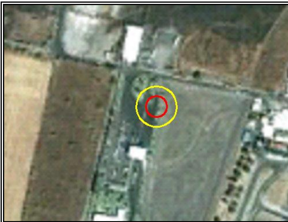
Figura VI.3.2.187 Evento 32.1 Incendio (Radiación Térmica). Zona de Alto Riesgo (ZAR) (5 KW/m 2 ) en color rojo y Zona de Amortiguamiento (ZA) (1.4 KW/m 2 ) en color amarillo.
