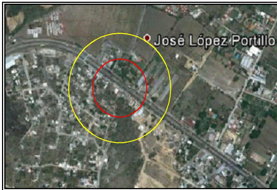
Figura VI.3.2.133 Evento 23.1 Incendio (Radiación Térmica). Zona de Alto Riesgo (ZAR) ( 5 \text{ KW/m}^2 ) en color rojo y Zona de Amortiguamiento (ZA) ( 1.4 \text{ KW/m}^2 ) en color amarillo.
