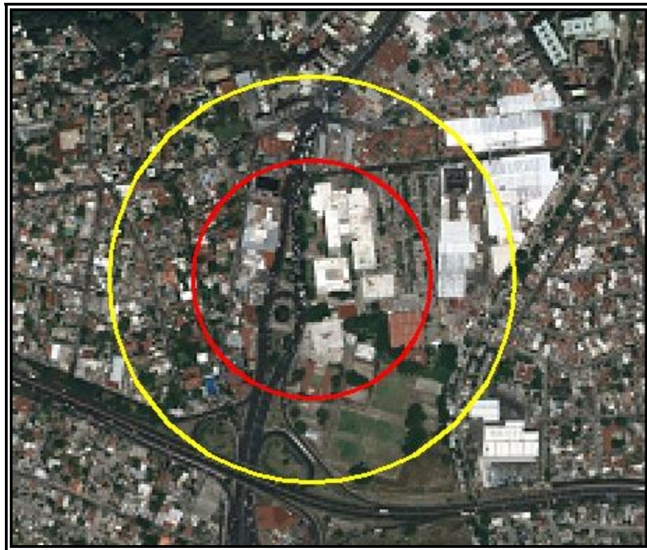
Figura VI.3.2.87 Evento 15.3 Explosión no Confinada (Sobrepresión). Zona de Alto Riesgo (ZAR) (1 PSI) en color rojo y Zona de Amortiguamiento (ZA) (0,5 PSI) en color amarillo.
