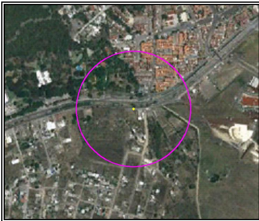
Figura VI.3.2.204 Evento 34.6. Radios de concentraciones de Gas Natural en partes por millón
