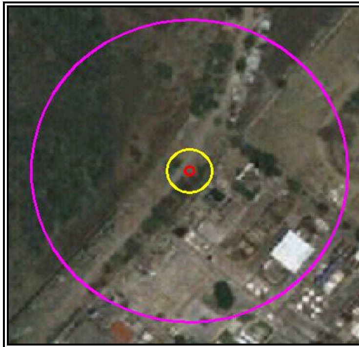
Figura VI.3.2.35 Evento 6.5. Radios de concentraciones de Gas Natural en partes por millón (ppm).
