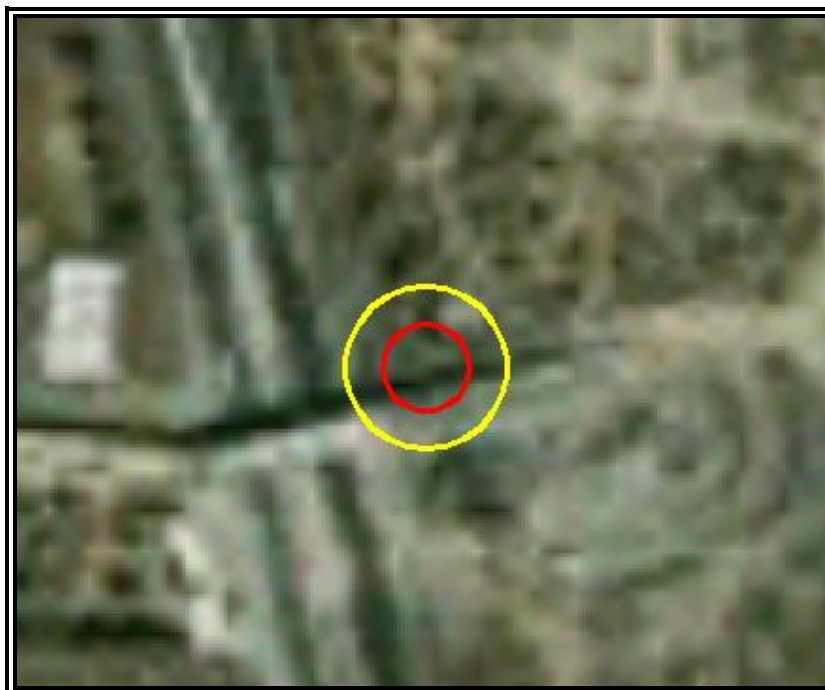
Figura VI.3.2.164 Evento 28.2 Incendio (Radiación Térmica). Zona de Alto Riesgo (ZAR) (5 \text{KW/m}^2 ) en color rojo y Zona de Amortiguamiento (ZA) (1.4 \text{KW/m}^2 ) en color amarillo.
