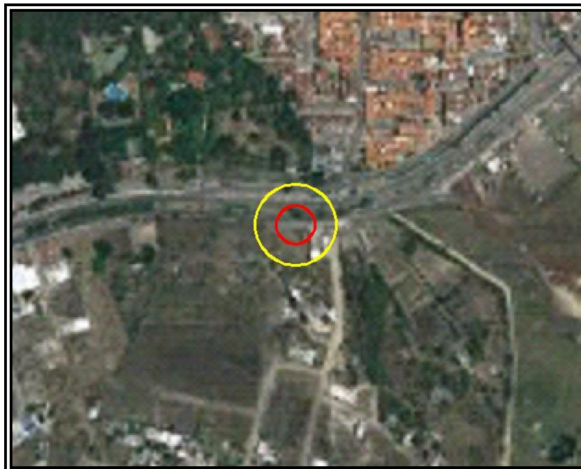
Figura VI.3.2.200 Evento 34.2 Incendio (Radiación Térmica). Zona de Alto Riesgo (ZAR) (5 KW/m 2 ) en color rojo y Zona de Amortiguamiento (ZA) (1.4 KW/m 2 ) en color amarillo.
