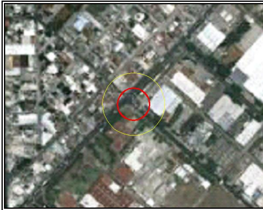
Figura VI.3.2.127 Evento 21.1 Incendio (Radiación Térmica). Zona de Alto Riesgo (ZAR) (5 \text{KW/m}^2 ) en color rojo y Zona de Amortiguamiento (ZA) (1.4 \text{KW/m}^2 ) en color amarillo.
