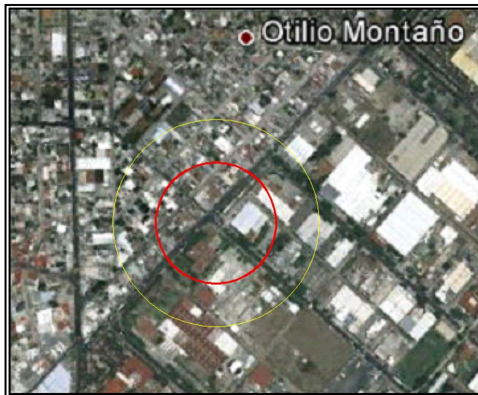
Figura VI.3.2.129 Evento 21.3 Explosión no Confinada (Sobrepresión). Zona de Alto Riesgo (ZAR) (1 PSI) en color rojo y Zona de Amortiguamiento (ZA) (0,5 PSI) en color amarillo.
