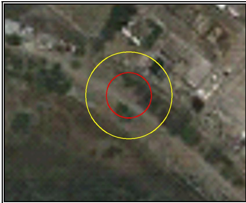
Figura VI.3.2.32 Evento 6.2 Incendio (Radiación Térmica). Zona de Alto Riesgo (ZAR) ( 5 \text{ KW/m}^2 ) en color rojo y Zona de Amortiguamiento (ZA) ( 1.4 \text{ KW/m}^2 ) en color amarillo.
