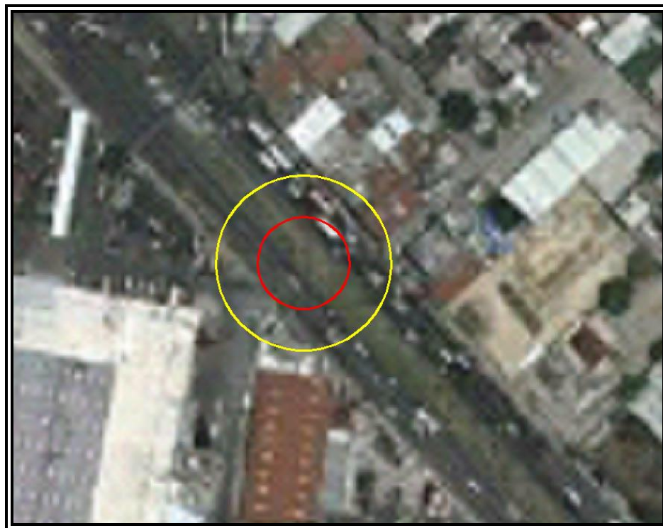
Figura VI.3.2.14 Evento 3.2 Incendio (Radiación Térmica). Zona de Alto Riesgo (ZAR) ( 5 \text{ KW/m}^2 )
