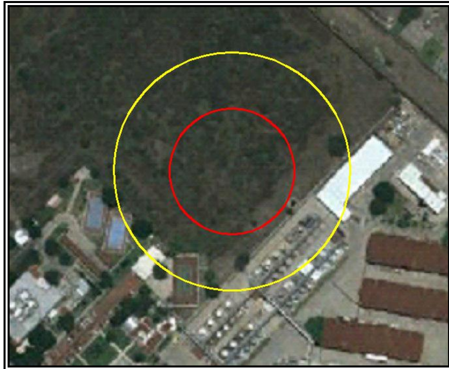
Figura VI.3.2.73 Evento 13.1 Incendio (Radiación Térmica). Zona de Alto Riesgo (ZAR) ( 5 \text{ KW/m}^2 ) en color rojo y Zona de Amortiguamiento (ZA) ( 1.4 \text{ KW/m}^2 ) en color amarillo.
