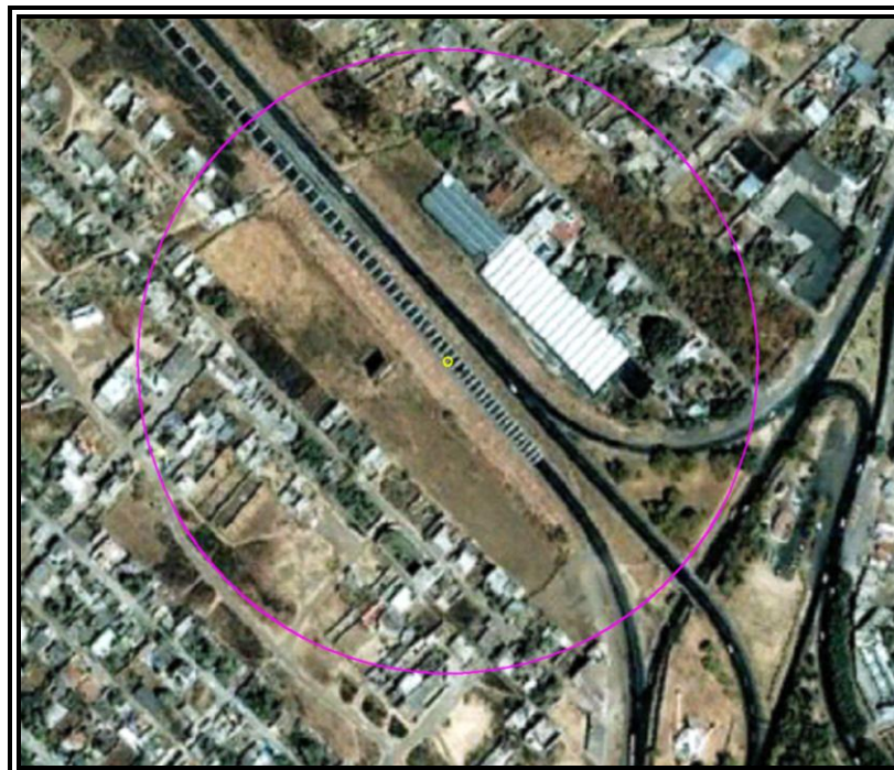
Figura VI.3.2.222 Evento 37.6. Radios de concentraciones de Gas Natural en partes por millón (ppm).
