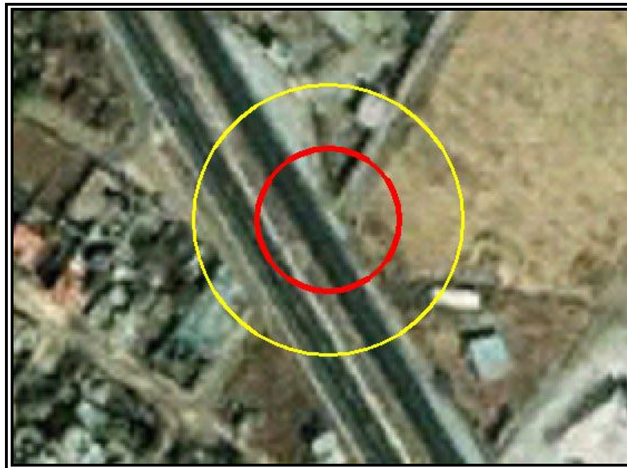
Figura VI.3.2.224 Evento 38.2 Incendio (Radiación Térmica). Zona de Alto Riesgo (ZAR) (5 KW/m 2 ) en color rojo y Zona de Amortiguamiento (ZA) (1.4 KW/m 2 ) en color amarillo.
