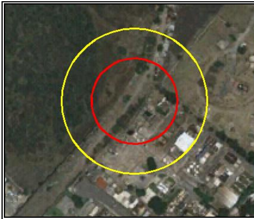
Figura VI.3.2.34 Evento 6.4 Explosión no Confinada (Sobrepresión). Zona de Alto Riesgo (ZAR) (1 PSI) en color rojo y Zona de Amortiguamiento (ZA) (0,5 PSI) en color amarillo.
