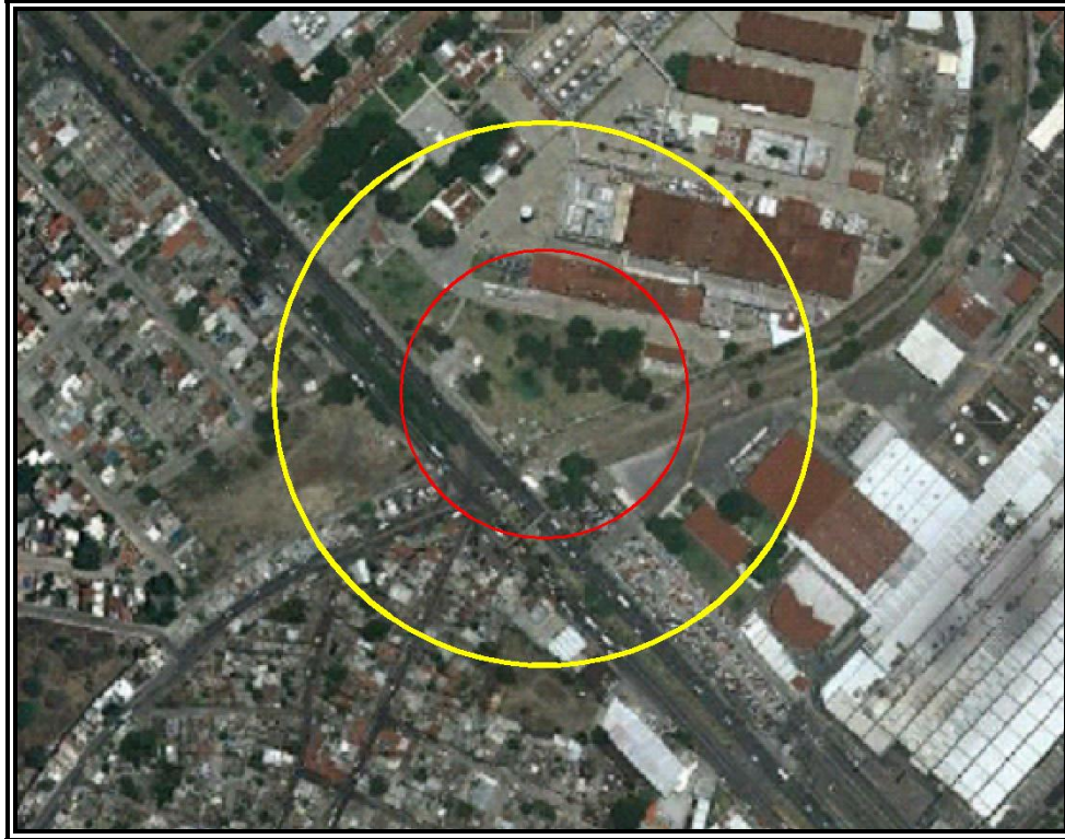
Figura VI.3.2.19 Evento 4.1 Incendio (Radiación Térmica). Zona de Alto Riesgo (ZAR) ( 5 \text{ KW/m}^2 ) en color rojo y Zona de Amortiguamiento (ZA) ( 1.4 \text{ KW/m}^2 ) en color amarillo.
