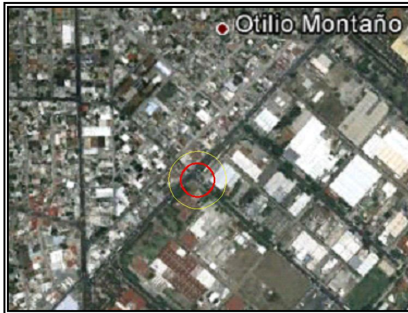
Figura VI.3.2.130 Evento 21.4 Explosión no Confinada (Sobrepresión). Zona de Alto Riesgo (ZAR) (1 PSI) en color rojo y Zona de Amortiguamiento (ZA) (0,5 PSI) en color amarillo.
