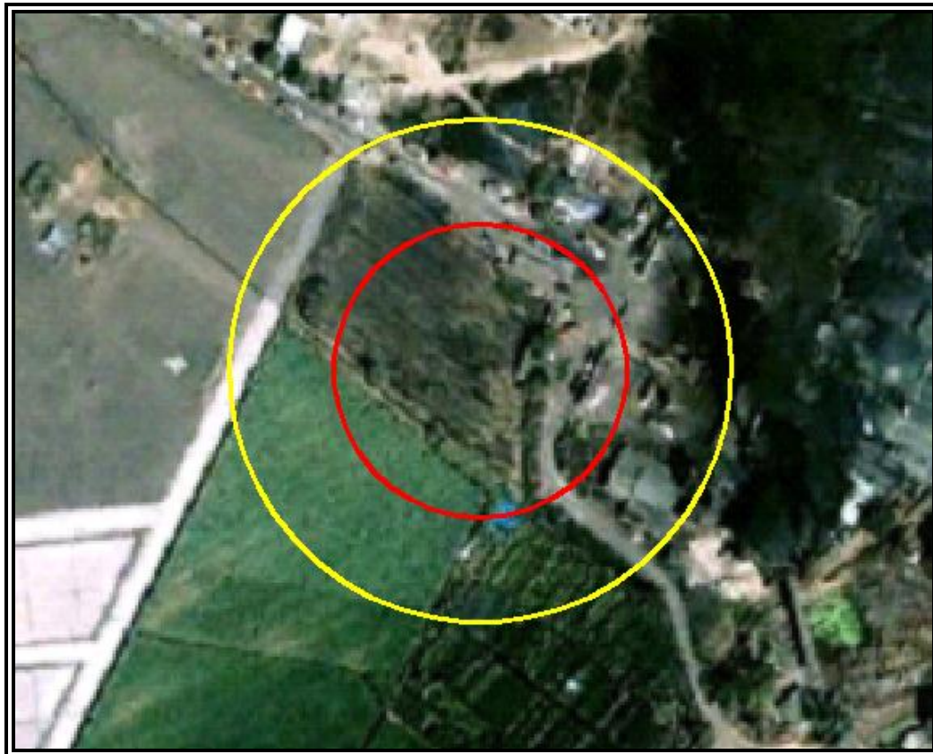
Figura VI.3.2.58 Evento 10.4 Explosión no Confinada (Sobrepresión). Zona de Alto Riesgo (ZAR) (1 PSI) en color rojo y Zona de Amortiguamiento (ZA) (0,5 PSI) en color amarillo.
