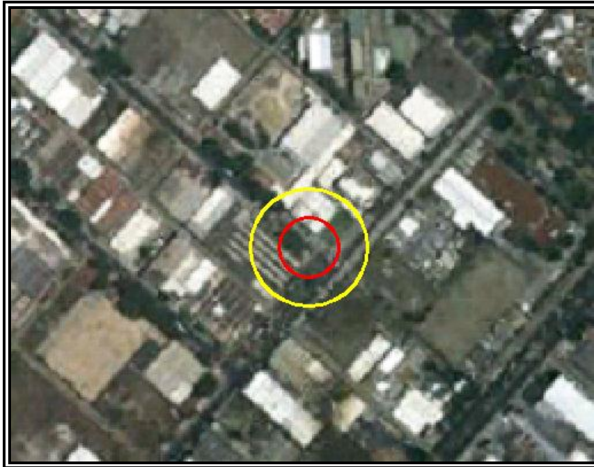
Figura VI.3.2.127 Evento 22.1 Incendio (Radiación Térmica). Zona de Alto Riesgo (ZAR) (5 KW/m 2 ) en color rojo y Zona de Amortiguamiento (ZA) (1.4 KW/m 2 ) en color amarillo.
