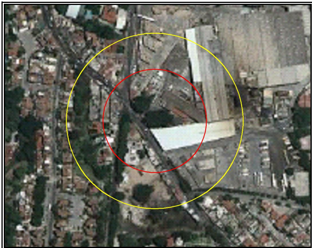
Figura VI.3.2.93 Evento 16.3 Explosión no Confinada (Sobrepresión). Zona de Alto Riesgo (ZAR) (1 PSI) en color rojo y Zona de Amortiguamiento (ZA) (0,5 PSI) en color amarillo.
