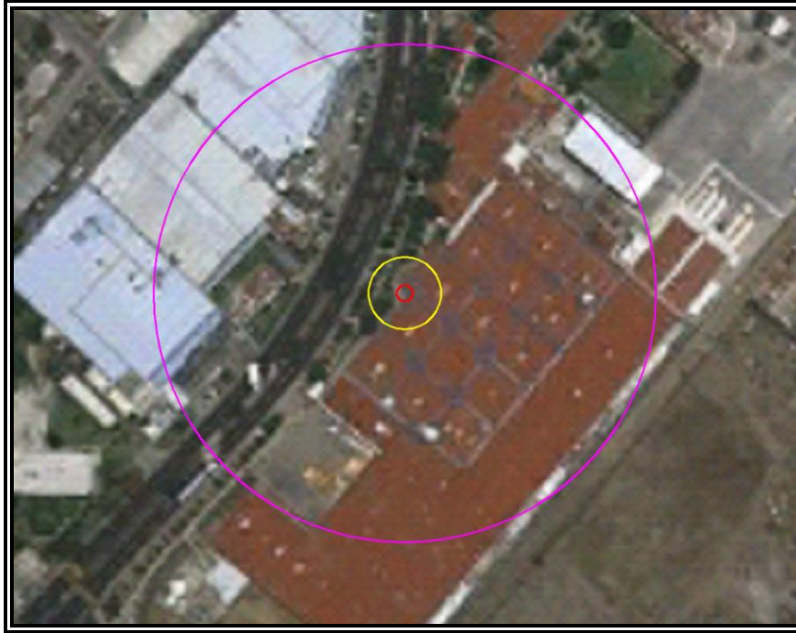
Figura VI.3.2.53 Evento 9.5. Radios de concentraciones de Gas Natural en partes por millón (ppm).
