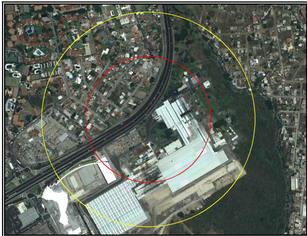
Figura VI.3.2.99 Evento 17.3 Explosión no Confinada (Sobrepresión). Zona de Alto Riesgo (ZAR) (1 PSI) en color rojo y Zona de Amortiguamiento (ZA) (0,5 PSI) en color amarillo.
