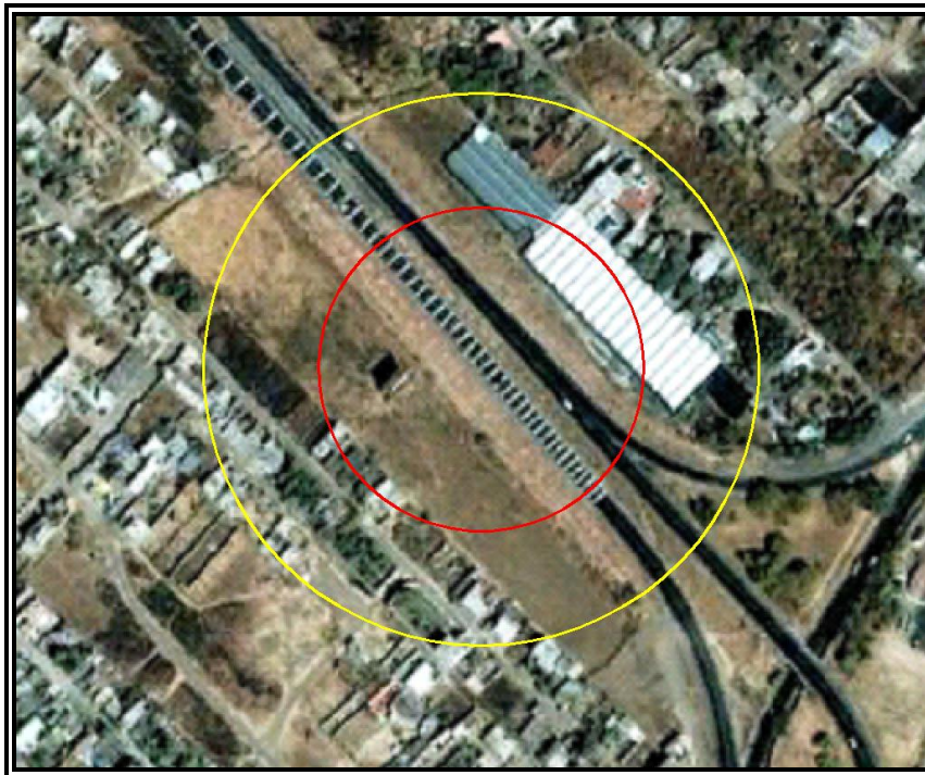
Figura VI.3.2.220 Evento 37.4 Explosión no Confinada (Sobrepresión). Zona de Alto Riesgo (ZAR) (1 PSI) en color rojo y Zona de Amortiguamiento (ZA) (0,5 PSI) en color amarillo.
