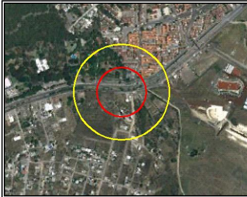
Figura VI.3.2.199 Evento 34.1 Incendio (Radiación Térmica). Zona de Alto Riesgo (ZAR) (5 KW/m 2 ) en color rojo y Zona de Amortiguamiento (ZA) (1.4 KW/m 2 ) en color amarillo.
