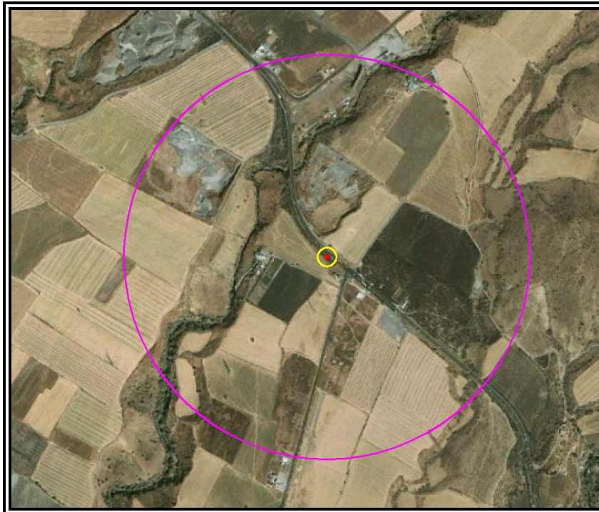
Figura VI.3.2.173 Evento 29.5. Radios de concentraciones de Gas Natural en partes por millón (ppm).
