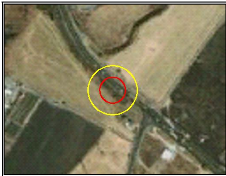
Figura VI.3.2.170 Evento 29.2 Incendio (Radiación Térmica). Zona de Alto Riesgo (ZAR) (5 KW/m 2 ) en color rojo y Zona de Amortiguamiento (ZA) (1.4 KW/m 2 ) en color amarillo.
