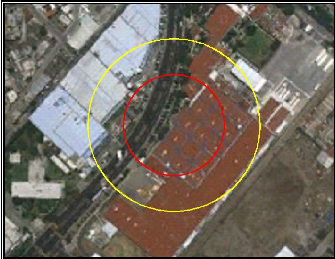
Figura VI.3.2.52 Evento 9.4 Explosión no Confinada (Sobrepresión). Zona de Alto Riesgo (ZAR) (1 PSI) en color rojo y Zona de Amortiguamiento (ZA) (0,5 PSI) en color amarillo.
