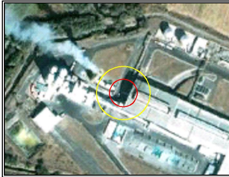
Figura VI.3.2.25 Evento 5.2 Incendio (Radiación Térmica). Zona de Alto Riesgo (ZAR) (5 KW/m 2 ) en color rojo y Zona de Amortiguamiento (ZA) (1.4 KW/m 2 ) en color amarillo.
