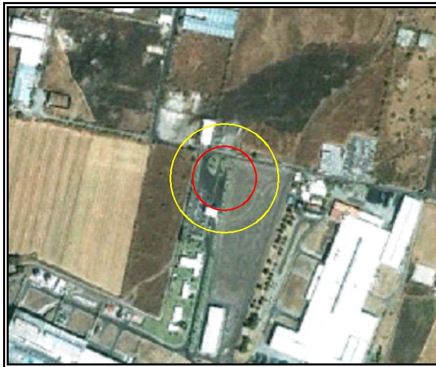
Figura VI.3.2.190 Evento 32.4 Explosión no Confinada (Sobrepresión). Zona de Alto Riesgo (ZAR) (1 PSI) en color rojo y Zona de Amortiguamiento (ZA) (0,5 PSI) en color amarillo.
