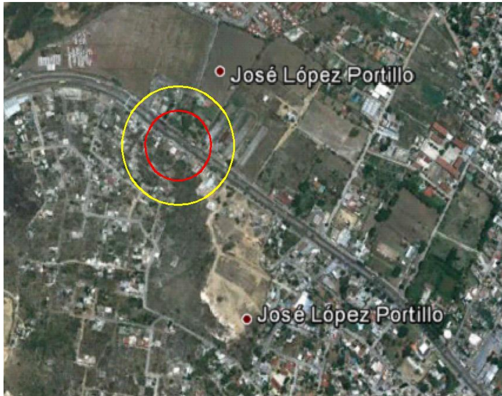
Figura VI.3.2.136 Evento 23.4 Explosión no Confinada (Sobrepresión). Zona de Alto Riesgo (ZAR) (1 PSI) en color rojo y Zona de Amortiguamiento (ZA) (0,5 PSI) en color amarillo.
