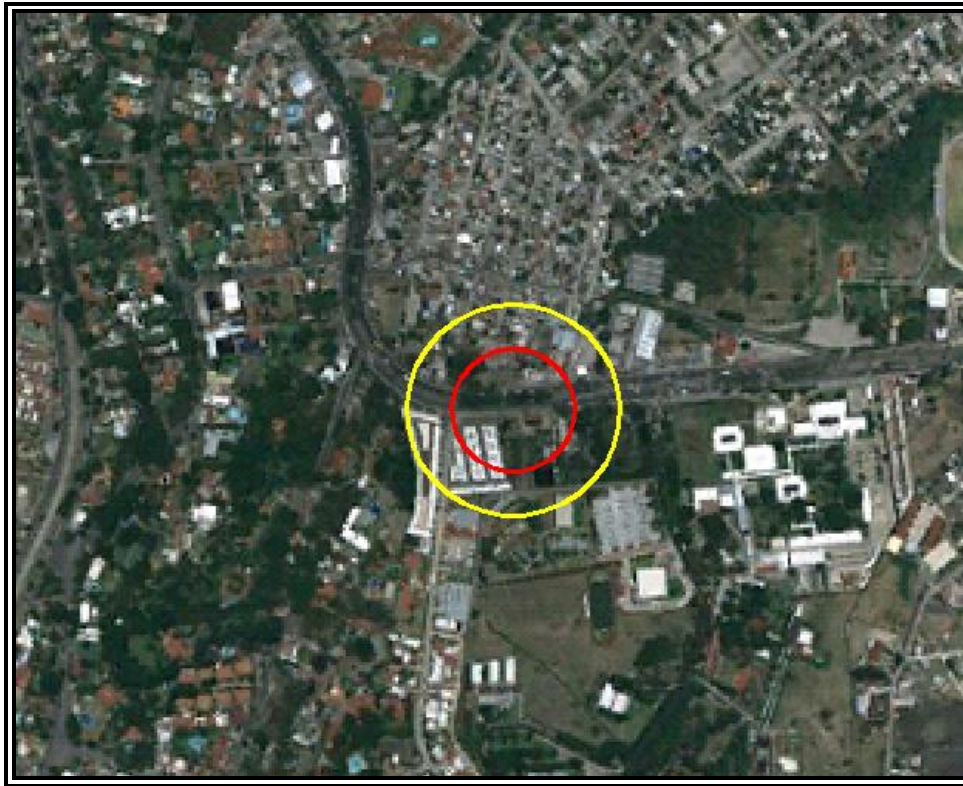
Figura VI.3.2.196 Evento 33.4 Explosión no Confinada (Sobrepresión). Zona de Alto Riesgo (ZAR) (1 PSI) en color rojo y Zona de Amortiguamiento (ZA) (0,5 PSI) en color amarillo.
