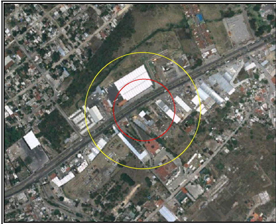
Figura VI.3.2.7 Evento 2.1 Incendio (Radiación Térmica). Zona de Alto Riesgo (ZAR) (5 KW/m 2 ) en color rojo y Zona de Amortiguamiento (ZA) (1.4 KW/m 2 ) en color amarillo.
