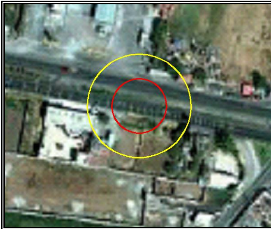
Figura VI.3.2.212 Evento 36.2 Incendio (Radiación Térmica). Zona de Alto Riesgo (ZAR) (5 KW/m 2 ) en color rojo y Zona de Amortiguamiento (ZA) (1.4 KW/m 2 ) en color amarillo.
