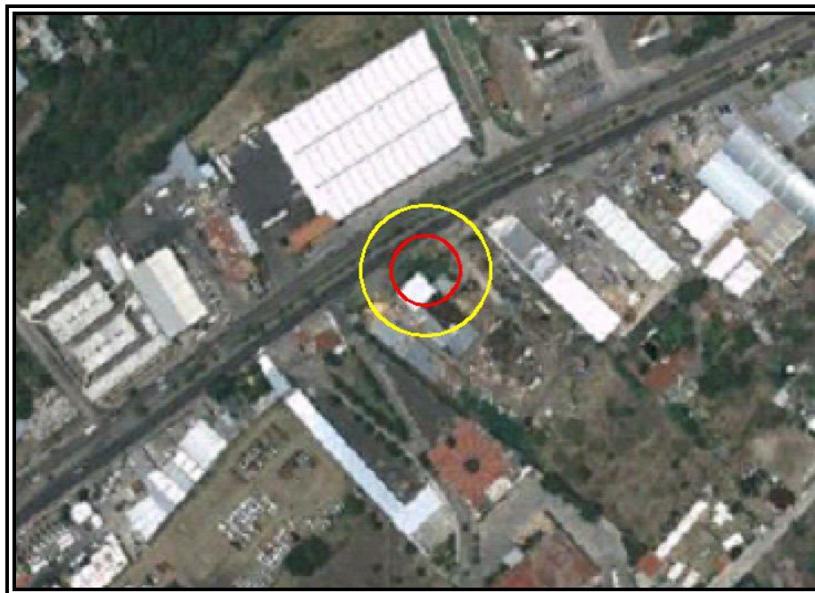
Figura VI.3.2.7 Evento 2.1 Incendio (Radiación Térmica). Zona de Alto Riesgo (ZAR) (5 KW/m 2 ) en color rojo y Zona de Amortiguamiento (ZA) (1.4 KW/m 2 ) en color amarillo.
