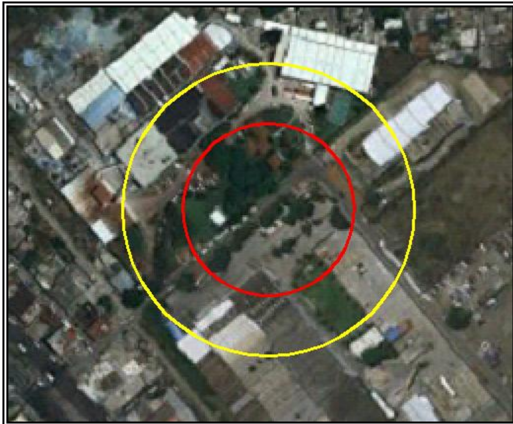
Figura VI.3.2.40 Evento 7.4 Explosión no Confinada (Sobrepresión). Zona de Alto Riesgo (ZAR) (1 PSI) en color rojo y Zona de Amortiguamiento (ZA) (0,5 PSI) en color amarillo.
