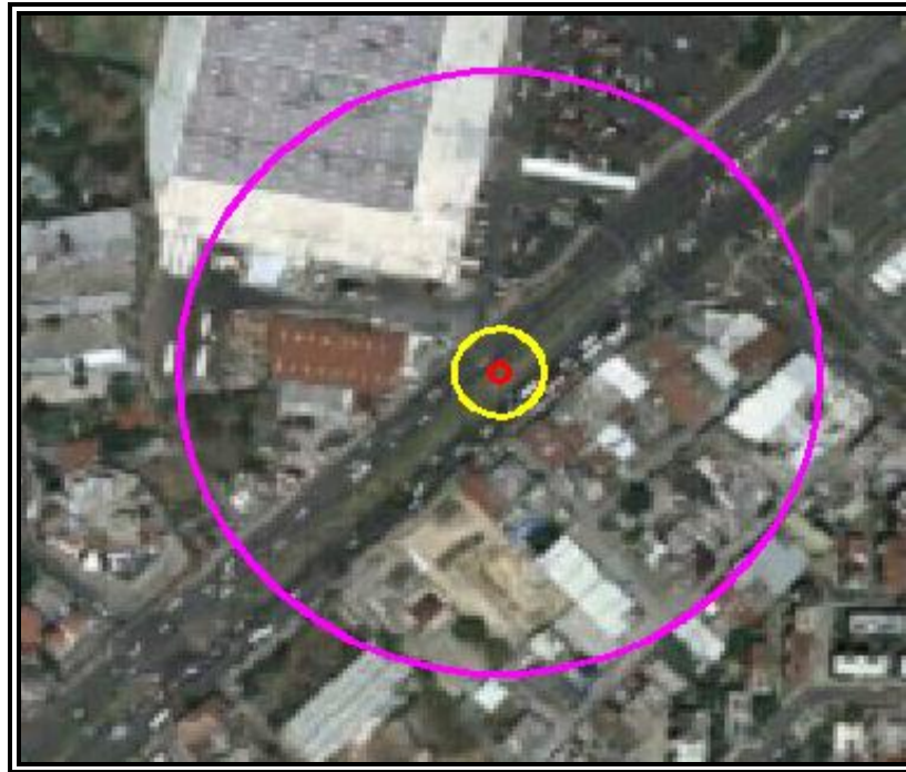
Figura VI.3.2.17 Evento 3.5. Radios de concentraciones de Gas Natural en partes por millón (ppm).
