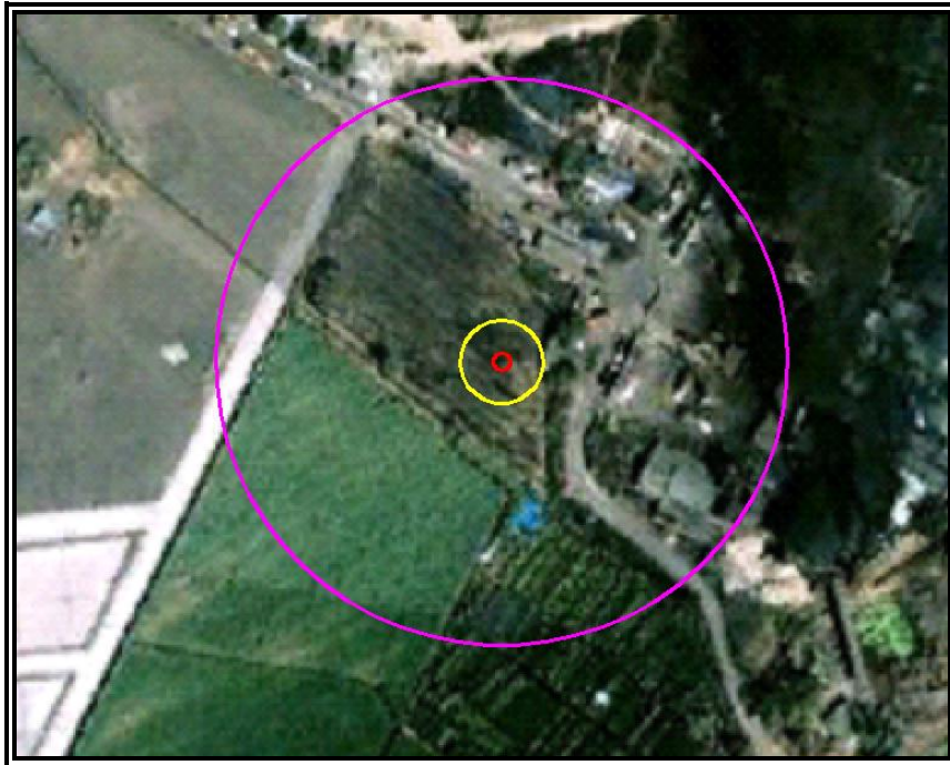
Figura VI.3.2.59 Evento 10.5. Radios de concentraciones de Gas Natural en partes por millón (ppm).
