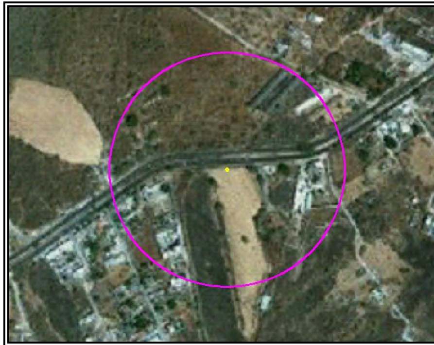
Figura VI.3.2.142 Evento 24.6. Radios de concentraciones de Gas Natural en partes por millón (ppm).
