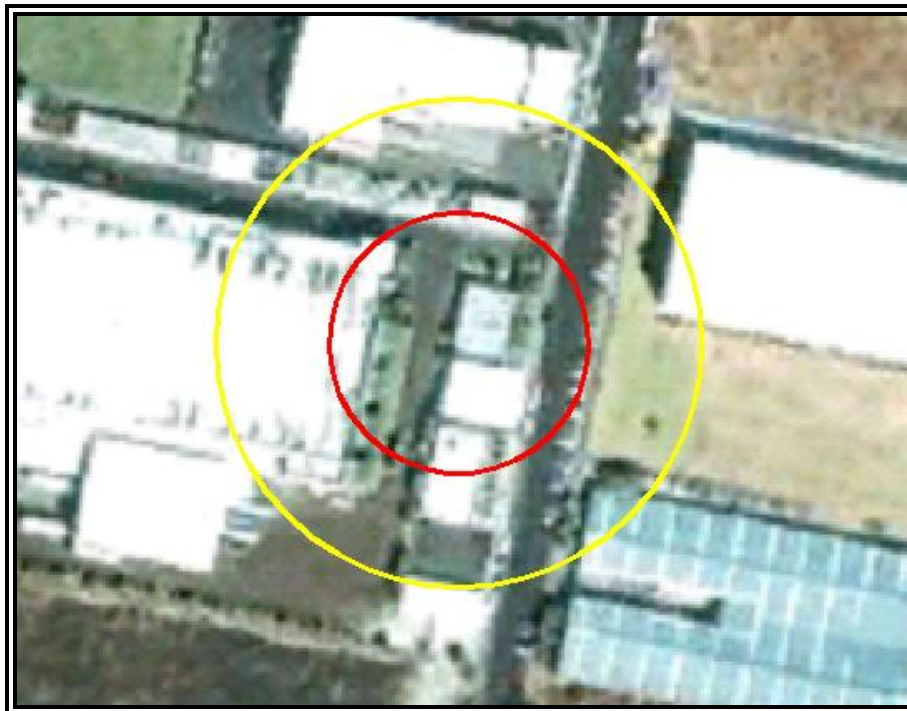
Figura VI.3.2.67 Evento 12.1 Incendio (Radiación Térmica). Zona de Alto Riesgo (ZAR) (5 KW/m 2 ) en color rojo y Zona de Amortiguamiento (ZA) (1.4 KW/m 2 ) en color amarillo.
