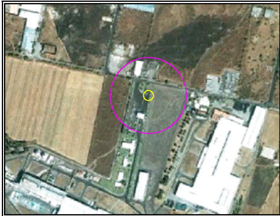
Figura VI.3.2.191 Evento 32.5. Radios de concentraciones de Gas Natural en partes por millón (ppm).
