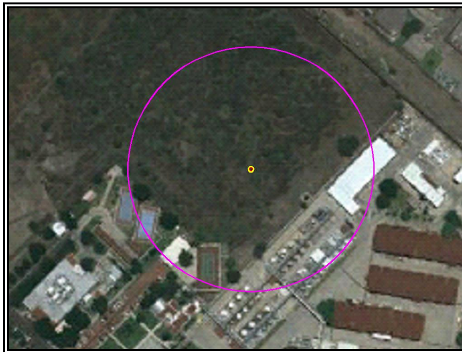
Figura VI.3.2.78 Evento 13.6. Radios de concentraciones de Gas Natural en partes por millón (ppm).
