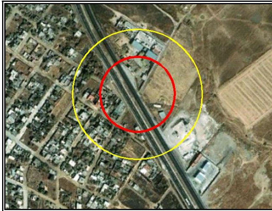
Figura VI.3.2.226 Evento 38.4 Explosión no Confinada (Sobrepresión). Zona de Alto Riesgo (ZAR) (1 PSI) en color rojo y Zona de Amortiguamiento (ZA) (0,5 PSI) en color amarillo.
