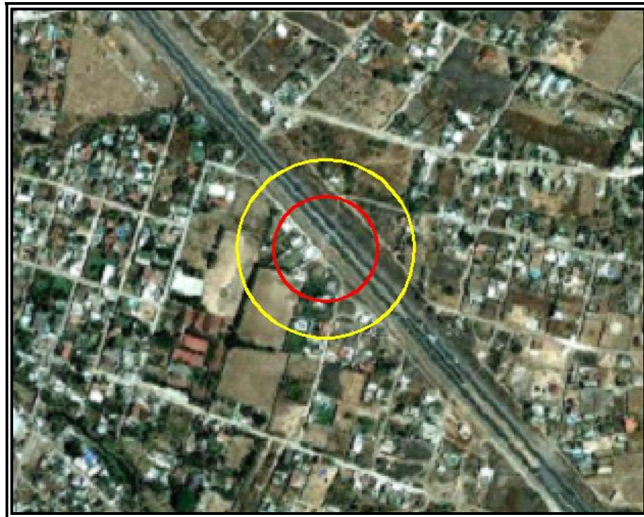
Figura VI.3.2.154 Evento 26.4 Explosión no Confinada (Sobrepresión). Zona de Alto Riesgo (ZAR) (1 PSI) en color rojo y Zona de Amortiguamiento (ZA) (0,5 PSI) en color amarillo.
