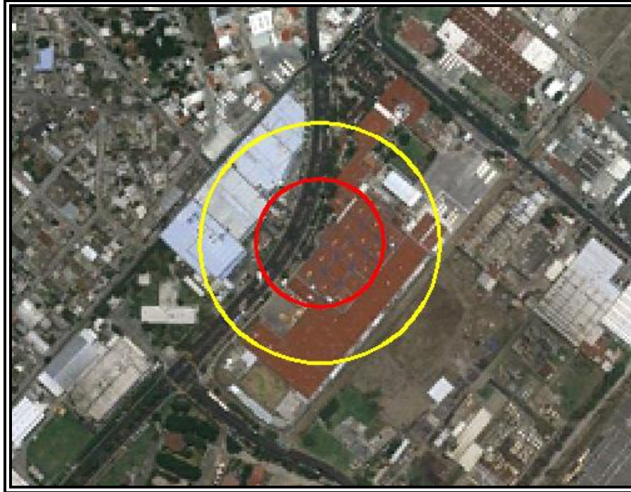
Figura VI.3.2.49 Evento 9.1 Incendio (Radiación Térmica). Zona de Alto Riesgo (ZAR) (5 KW/m 2 ) en color rojo y Zona de Amortiguamiento (ZA) (1.4 KW/m 2 ) en color amarillo.
