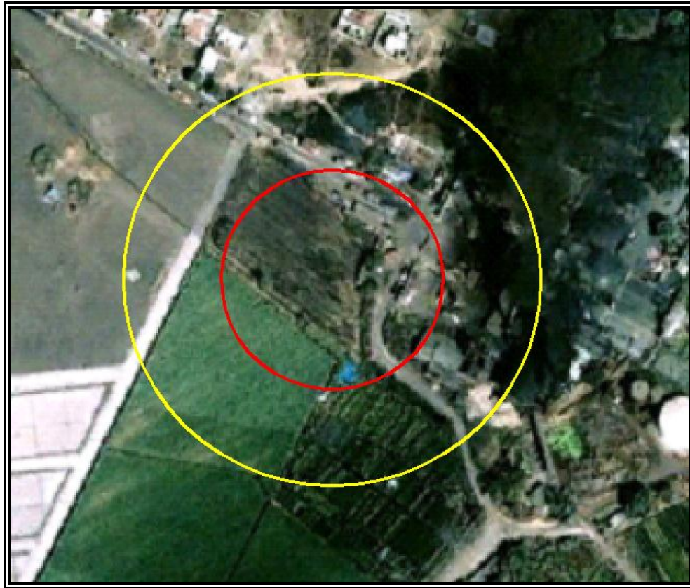
Figura VI.3.2.55 Evento 10.1 Incendio (Radiación Térmica). Zona de Alto Riesgo (ZAR) ( 5 \text{ kW/m}^2 ) en color rojo y Zona de Amortiguamiento (ZA) ( 1.4 \text{ kW/m}^2 ) en color amarillo.
