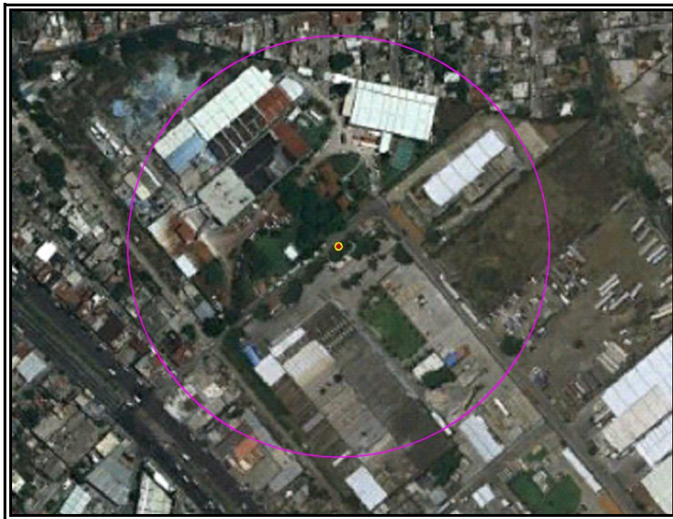
Figura VI.3.2.42 Evento 7.6. Radios de concentraciones de Gas Natural en partes por millón
