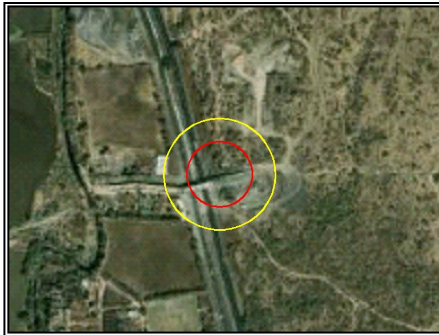
Figura VI.3.2.166 Evento 28.4 Explosión no Confinada (Sobrepresión). Zona de Alto Riesgo (ZAR) (1 PSI) en color rojo y Zona de Amortiguamiento (ZA) (0,5 PSI) en color amarillo.
