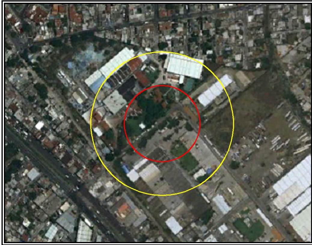
Figura VI.3.2.37 Evento 7.1 Incendio (Radiación Térmica). Zona de Alto Riesgo (ZAR) ( 5 \text{ KW/m}^2 ) en color rojo y Zona de Amortiguamiento (ZA) ( 1.4 \text{ KW/m}^2 ) en color amarillo.
