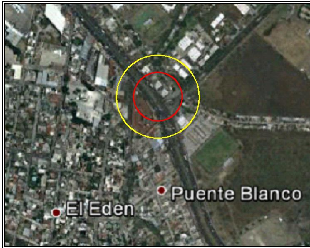
Figura VI.3.2.113 Evento 19.4 Explosión no Confinada (Sobrepresión). Zona de Alto Riesgo (ZAR) (1 PSI) en color rojo y Zona de Amortiguamiento (ZA) (0,5 PSI) en color amarillo.
