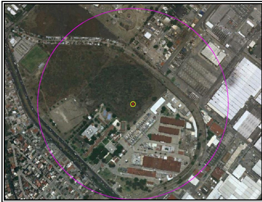
Figura VI.3.2.77 Evento 13.5. Radios de concentraciones de Gas Natural en partes por millón (ppm).
