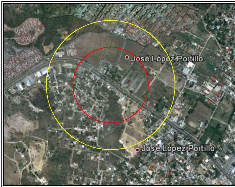
Figura VI.3.2.135 Evento 23.3 Explosión no Confinada (Sobrepresión). Zona de Alto Riesgo (ZAR) (1 PSI) en color rojo y Zona de Amortiguamiento (ZA) (0,5 PSI) en color amarillo.
