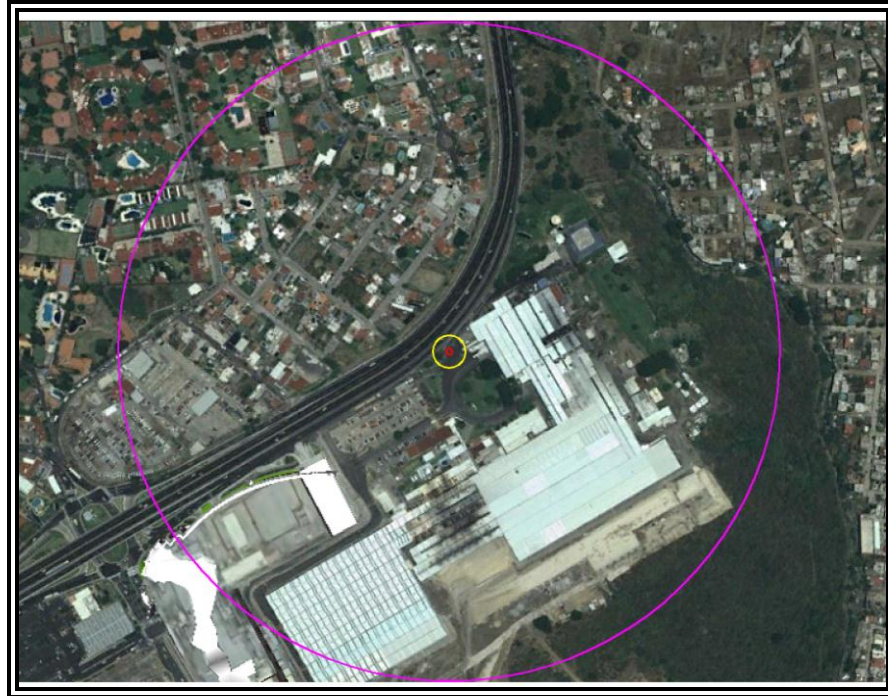
Figura VI.3.2.101 Evento 17.5. Radios de concentraciones de Gas Natural en partes por millón (ppm).
