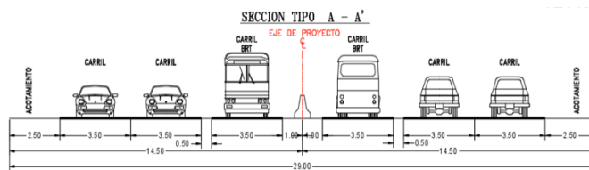
FIGURA II-21 SECCIÓN TIPO EN TANGENTE DEL KM 41+340 AL 42+290
