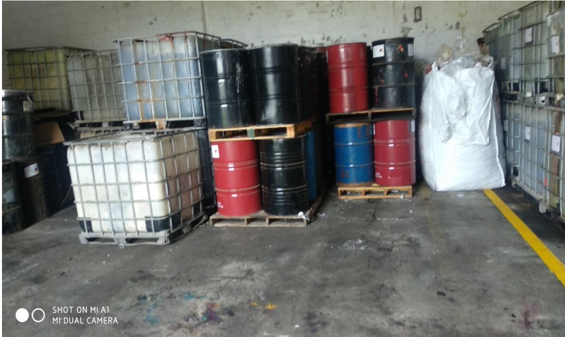
Figura 27. Almacenamiento temporal de residuos peligrosos.
