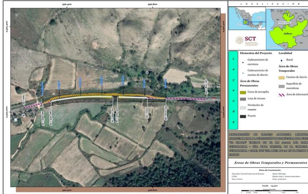
**Figura 7. Distribución de obras del Puente “El Zapote”**
