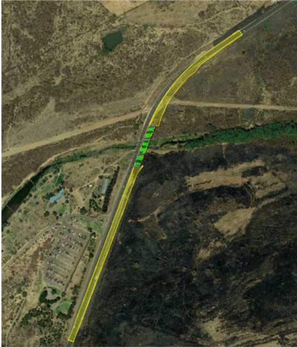
Figura 2.2. Imagen de satélite del tramo del proyecto, se indican en amarillo los carriles de acceso y en verde la estructura del nuevo puente.
