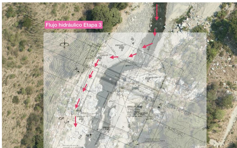
Imagen 14. Etapa 3, presa derivadora completa con compuerta abierta
