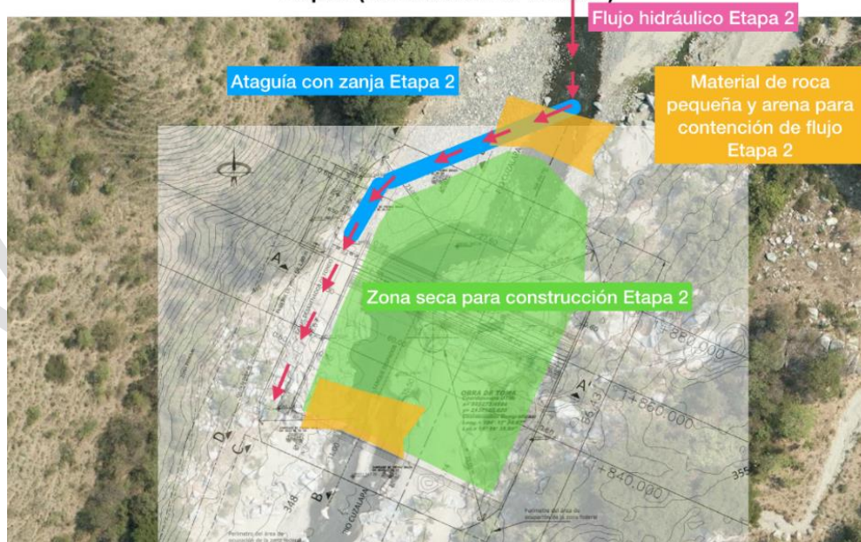
Imagen 13. Etapa 2, construcción de vertedor
