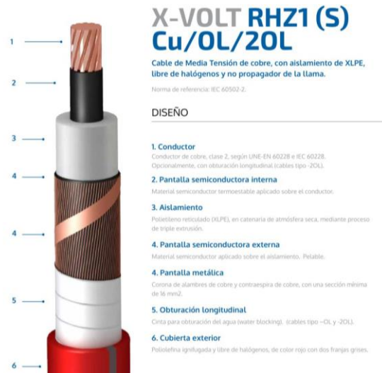
Figura II.9 Características de los cables RHZ1 (MT)
