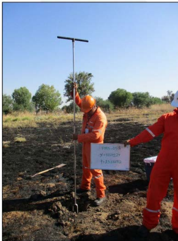
Figura IV.18 Equipo de perforación para la realización de sondeos y toma de muestras de suelo.
