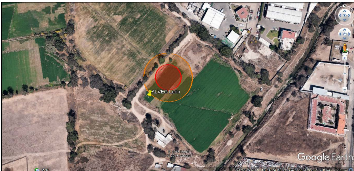
Figura IV.2 Evento: INCENDIO. Derrame de Acetona en tanque almacén V-103-A/B/C debido a ruptura.
