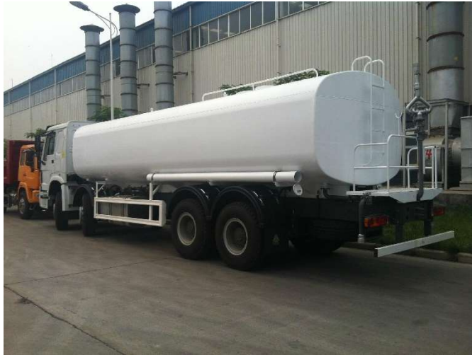
Figura II.27. Camión transportando agua con una capacidad de 20m 3
