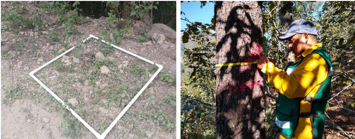
Figura IV-23. Técnicas de muestreo con cuadrantes de 1x1 m para vegetación herbácea (izquierda), y medida del DAP con cinta diamétrica (derecha) en sitios del SAR y AP.
