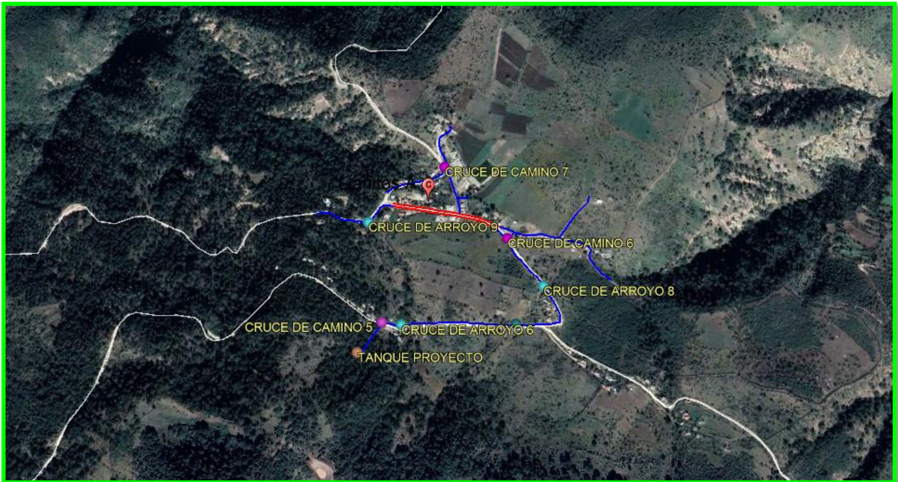
Ilustración 62. Trazo de la línea de distribución zona baja, con sus respectivos cruces de caminos y arroyos.
