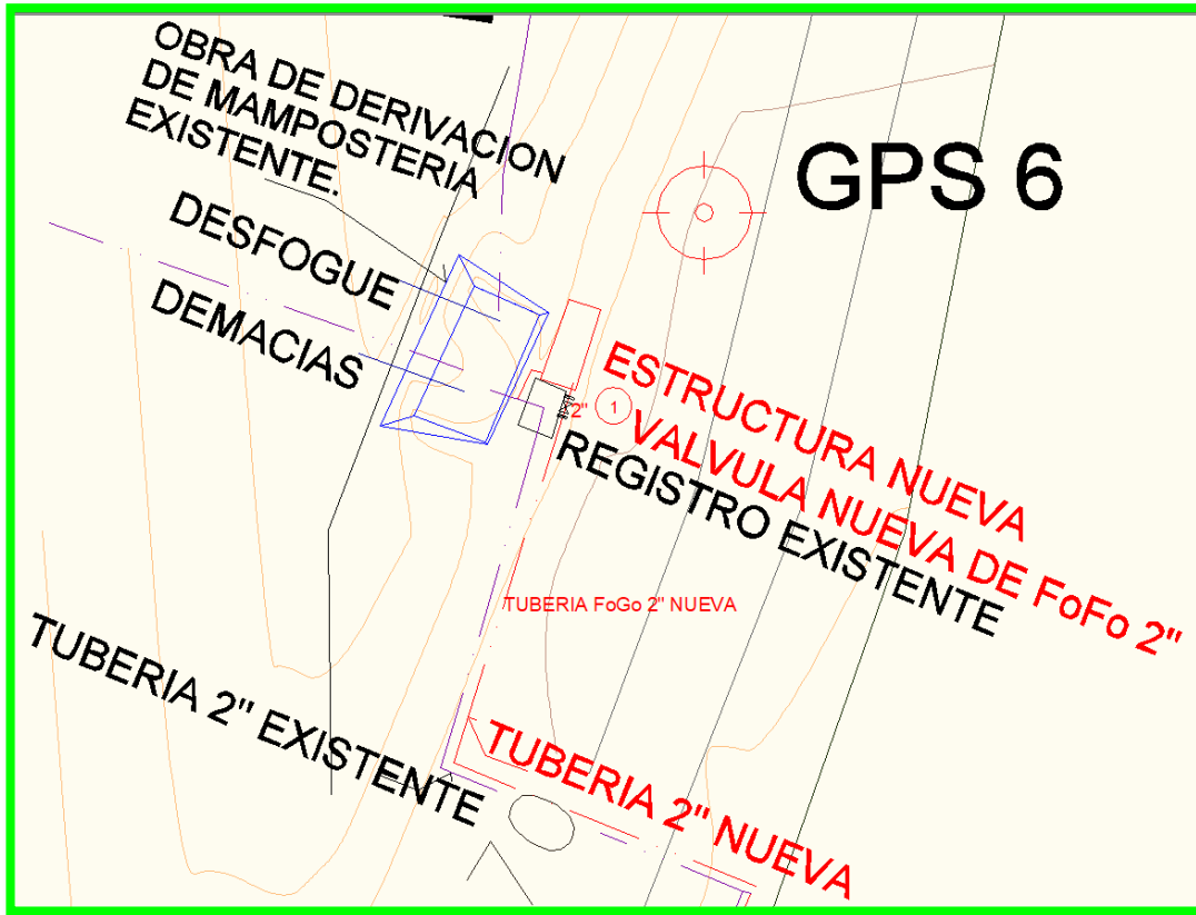
Ilustración 50. Detalle de colocación de tubería paralela a la existente para evitar daños innecesarios.
