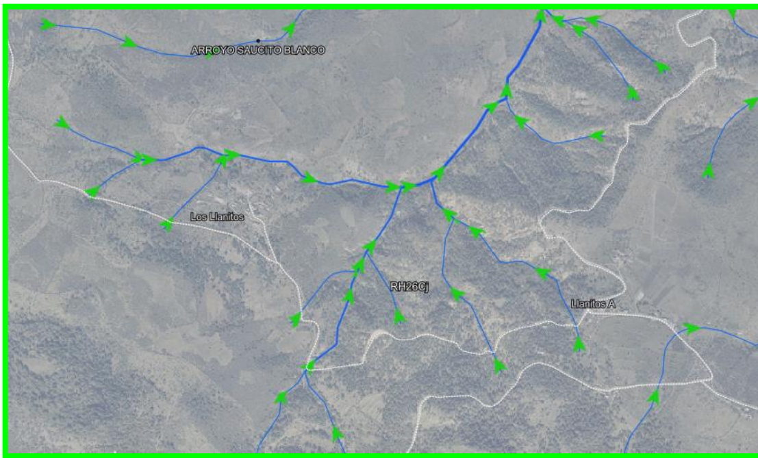
Ilustración 25. Dirección del flujo, producto de la topografía.
