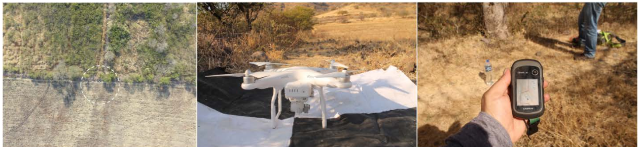
Imagen 33. En cada punto de despegue se tomó una coordenada con la ayuda de un GPS y posteriormente se tomó una fotografía aérea perpendicular con el Drone para tener una referencia espacial ubicando una diana de control.
