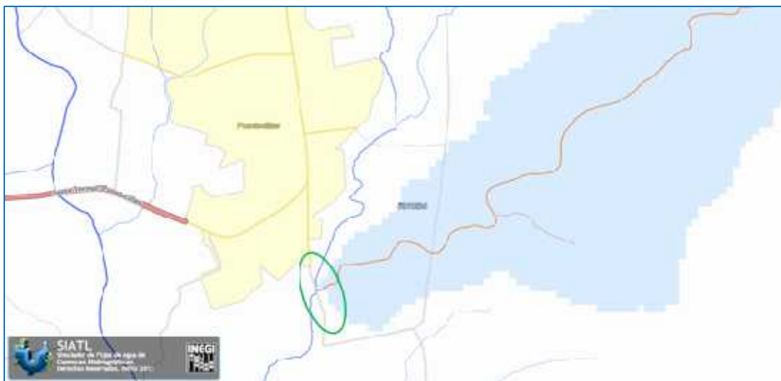
Figura 26. Se muestra la intercepción del arroyo Carboneras con el eje del proyecto justamente en el cadenamamiento 0+256.20 (ovalo color verde).
