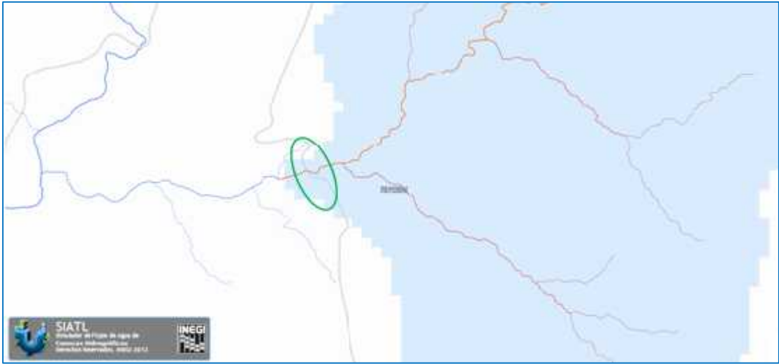
Figura 72. Se muestra la intercepción de la corriente intermitente con el eje del proyecto justamente en el cadenamiento 1+583.37 (ovalo color verde).
