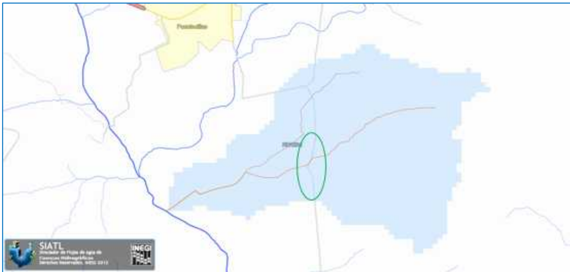
Figura 34. Se muestra la intersección de la corriente intermitente con el eje del proyecto justamente en el cadenamiento 1+448.77 (ovalo color verde).
