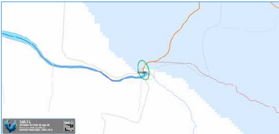
Figura 76. Se muestra la intercepción de la corriente intermitente con el eje del proyecto justamente en el cadenamamiento 4+940 (ovalo color verde).
