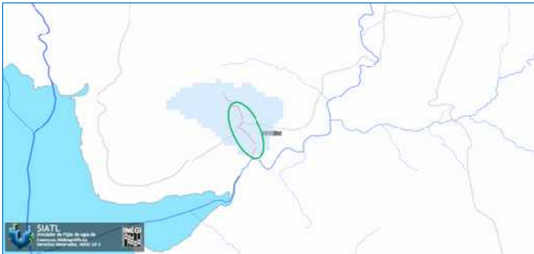
Figura 49. Se muestra la intercepción de la corriente intermitente con el eje del proyecto justamente en el cadenamiento 6+131.68 (ovalo color verde).
