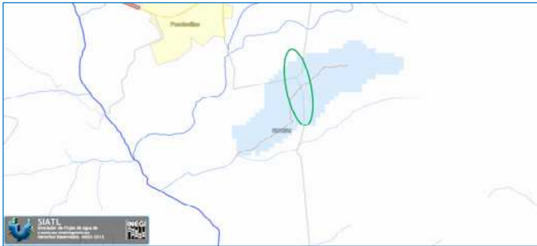
Figura 30. Se muestra la intercepción de la corriente intermitente con el eje del proyecto justamente en el cadenamamiento 0+996.60 (ovalo color verde).
