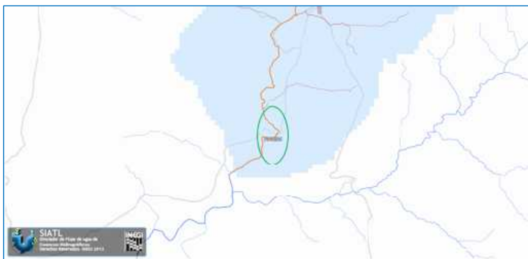
Figura 57. Se muestra la intercepción de la corriente intermitente con el eje del proyecto justamente en el cadenamiento 7+312.29 (ovalo color verde).
