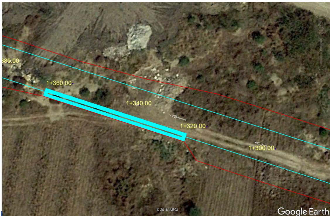
Figura 28. Ubicación de muro de contención (poligonal azul turquesa) en el Eje P-2 para evitar afectación a predio colindante. La línea azul turquesa representa el ancho de corona proyectado y la Línea Roja la línea de ceros.
