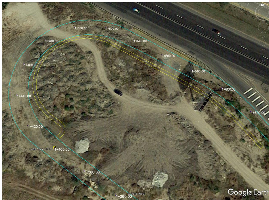
Figura 42. Ubicación del canal de tierra proyectado. La línea amarilla representa la ubicación del canal de tierra y la línea azul turquesa los hombros proyectados.
