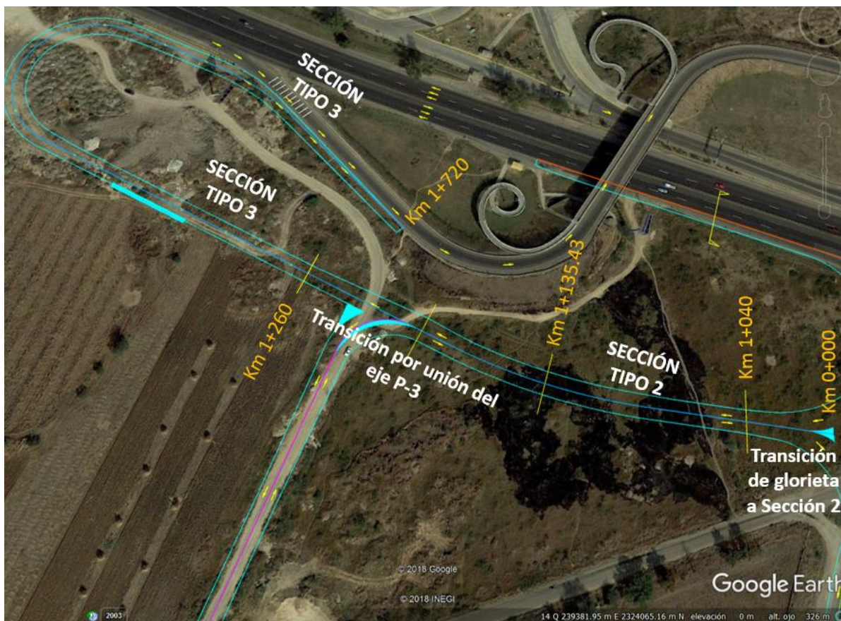
Figura 13. Secciones tipo que conforman el Eje P-2
