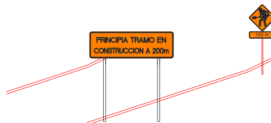
Figura 46. Colocación de señales previo inicio del proceso constructivo
