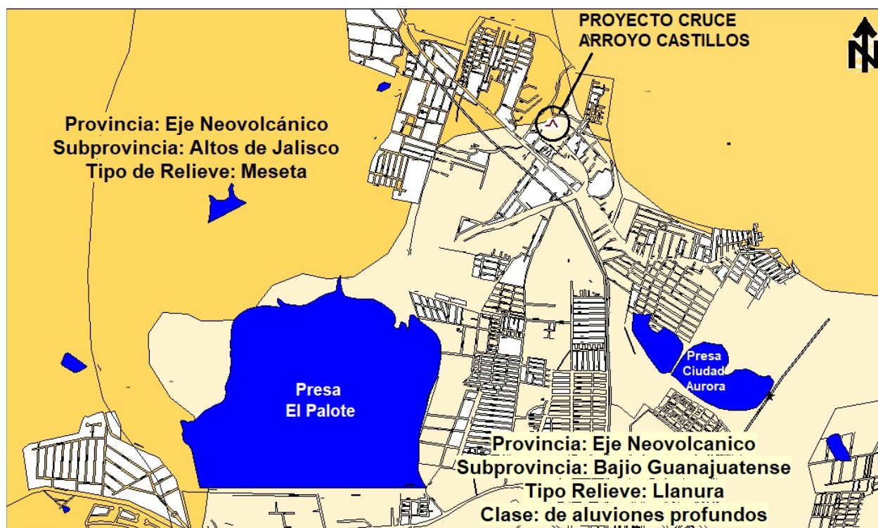
Figura 4.3 Mapa Fisiográfico en la zona del proyecto del cruce del arroyo Los Castillos.
