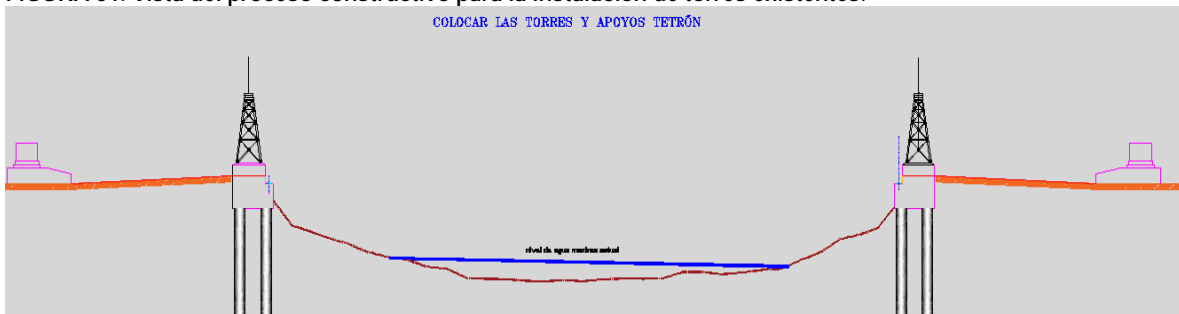
FIGURA 51. Vista del proceso constructivo para la instalación de torres existentes.
