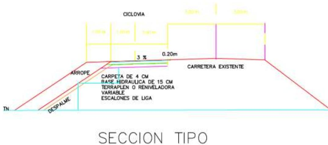
Figura II-4. Sección tipo del tramo 1
