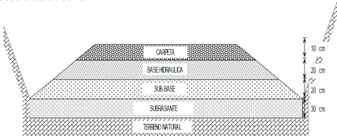
En las zonas donde existen cortes, se escarificará la superficie descubierta en un espesor de 30 cm y se compactará y se le dará la pendiente del 2% del bombeo y esta quedará como capa subrasante.
