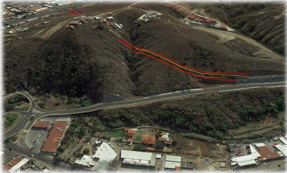
Se muestra la traza propuesta para el emplazamiento de la vialidad de retorno, donde se destaca la ubicación subterránea de por lo menos 265.68 metros, destacando la ocupación del suelo de superficie por área de viviendas y antenas.
