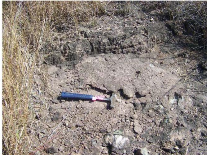
Con los datos obtenidos en el tramo involucrado del proyecto del túnel Euquerio Guerrero se determinó que la litología es propicia para su ejecución, ya que la roca presenta compactación, resistencia y buena estabilidad, amparando esto por el túnel el Laurel situado cercanamente en una de las faldas del mismo cerro el cual no presenta fallas o estructuras considerables que afecten la firmeza, duración y riego de la obra subterránea.
