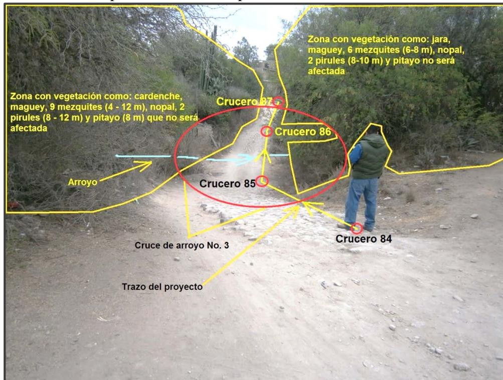
En la imagen, se observa la dirección del trazo del proyecto y el cruce de arroyo No. 3 en el tramo comprendido entre los cruces 85, 86, 87 y 88; donde no se afectará ningún tipo de vegetación al proyectarse por camino de terracería dicho tramo
