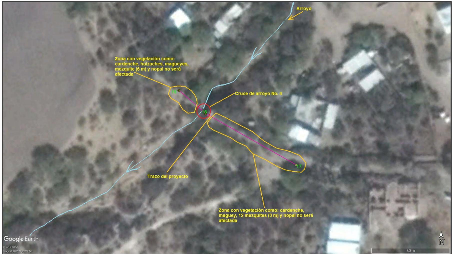
**Vista de la zona del cruce de arroyo No. 4 entre los cruceros 15 y 16. En dicha zona no se afectará ningún tipo de vegetación debido a que la instalación se realizará en forma aérea, siendo el resto de trazo en zona federal tanto previa como posterior al cruce con el tendido de la tubería en forma superficial sin excavación. Se respetará la totalidad de la vegetación de las colindancias como: cardenche, huizache, maguey, mezquite y nopal al no requerir excavación alguna.**
