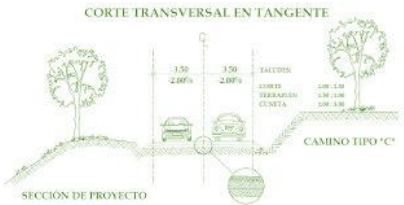
Ilustración 2 Corte de carretera tipo C
