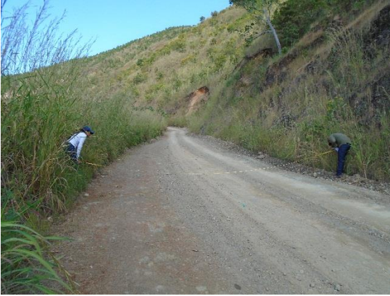
Medición del camino y toma de datos. 8 m. de ancho del camino actual con Pastizal Inducido
