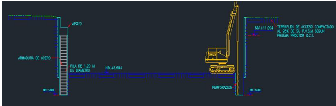
Figura 15. Colado de pilas y apoyos
