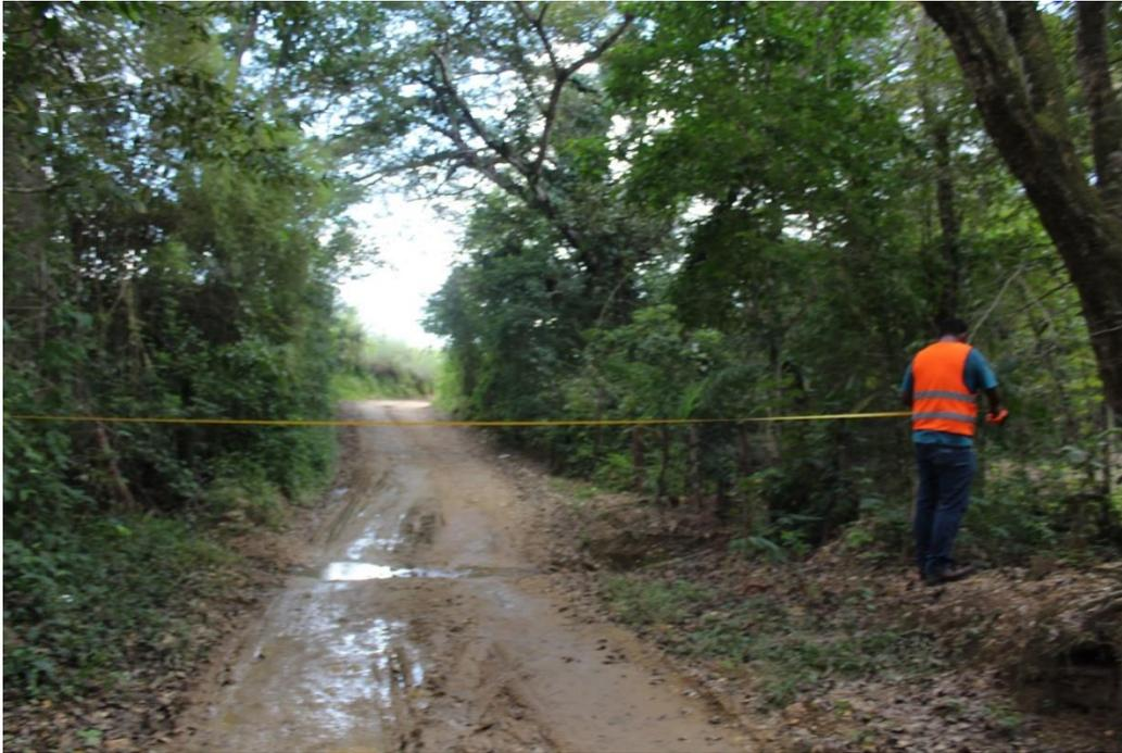
**Ilustración 37. Medición del ancho del camino actual**
