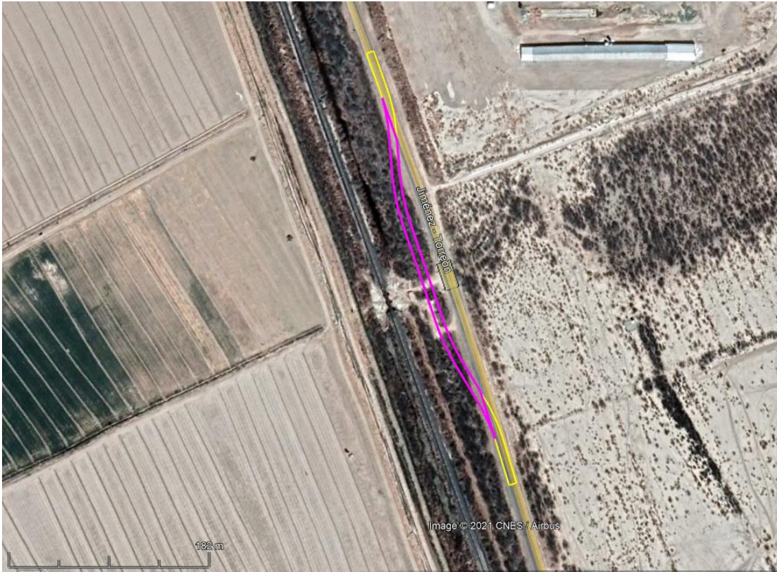
Figura No. 17 Trazo del camino de desvío de tipo temporal con una longitud de 420 m.
