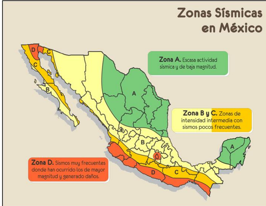
Figura IV. 30. Zonas sísmicas en México.
